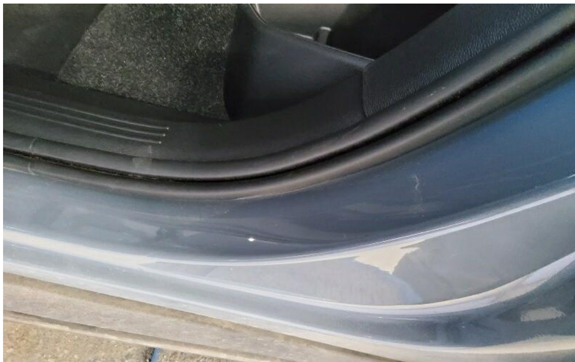
Bild 17 : Tür hinten links Einstieg, zerkratzt, Gebrauchsspur
