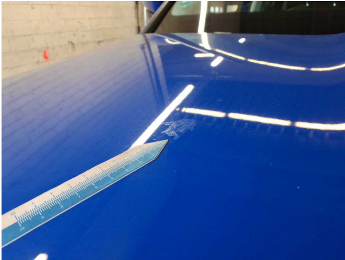
Damage 8: Bonnet: Bonnet (Vogelkotverätzung eingebrannt + Kratzer) - Paint defect - Paint
