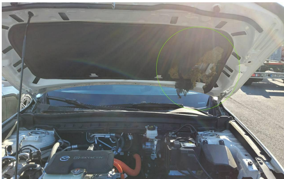
Bild 20 : Dämmmatte Motorhaube, Tierverbiss
