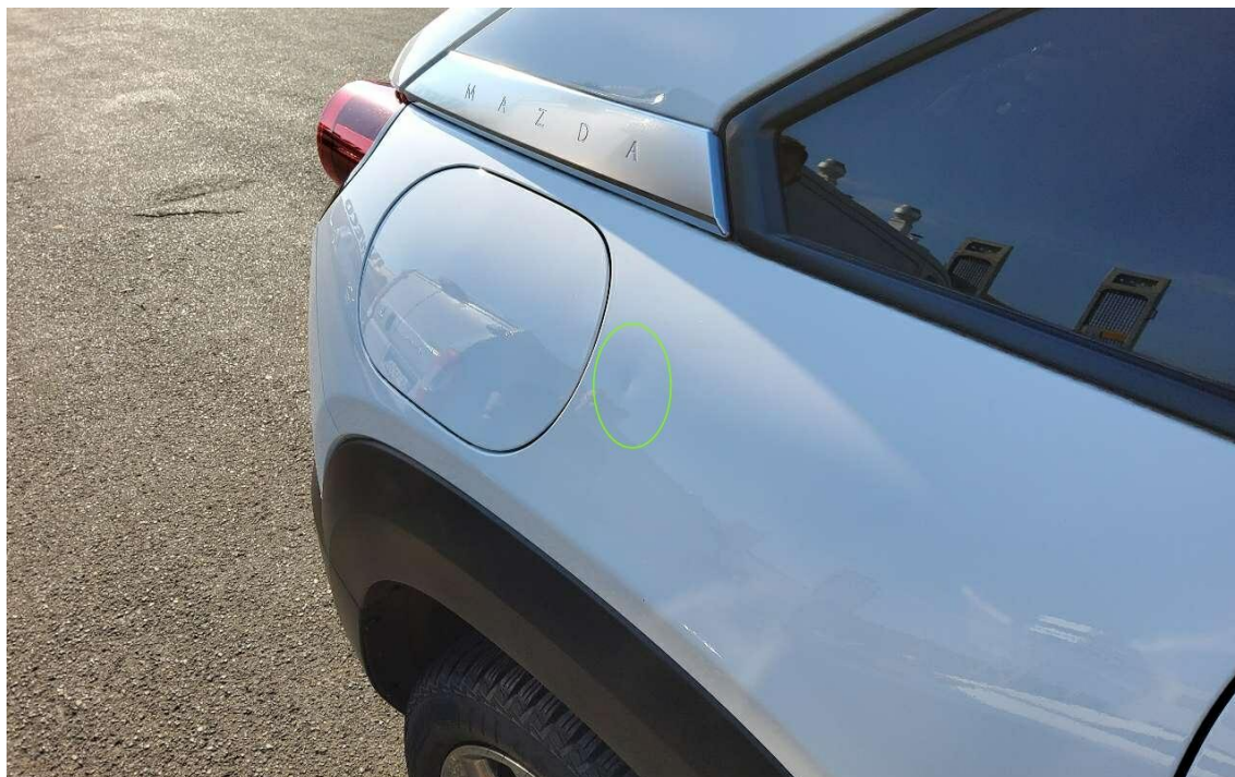
Bild 15 : Seitenteil hinten rechts, eingedellt, drücken
