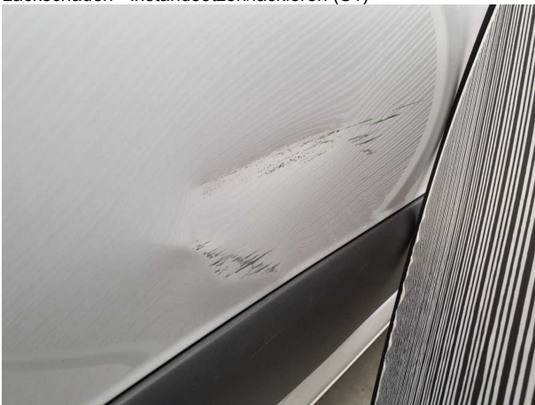
Beschädigung #10: Schiebetür rechts: Schiebetür - Delle / Lackschaden - instandsetzen/lackieren (S1)
