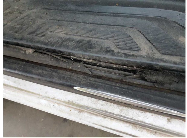
Beschädigung #1: Tür vorn links: Türdichtung - gebrochen / gerissen - erneuern
