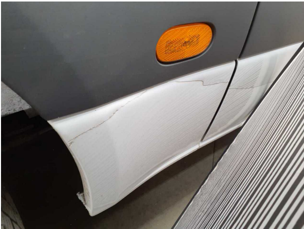
Beschädigung #9: Seitenwand rechts: Seitenwand (Beplankung mitte unten) - Delle / Lackschaden - instandsetzen und lackieren
