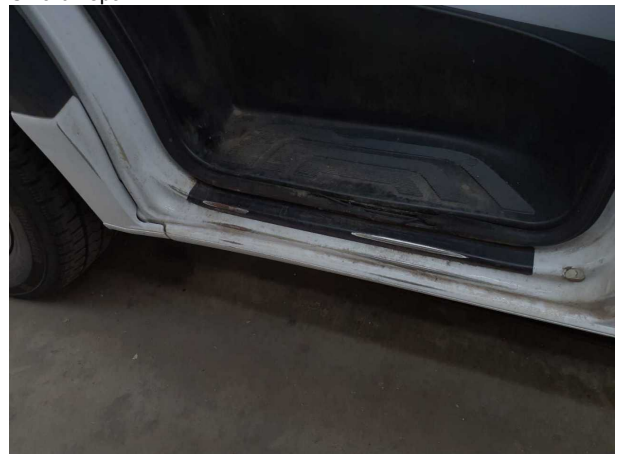
Beschädigung #6: Schweller links: Einstieg - Lackmangel - lackieren
