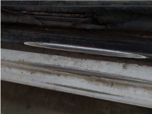
Beschädigung #6: Schweller links: Einstieg - Lackmangel - lackieren
