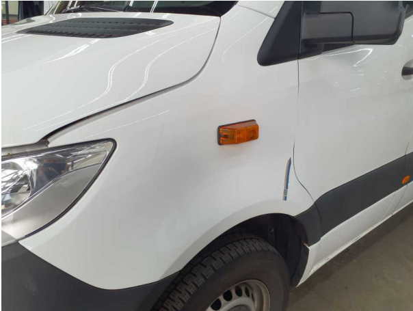
Beschädigung #4: Kotflügel links: Kotflügel links - Delle(n) - Smart Repair
