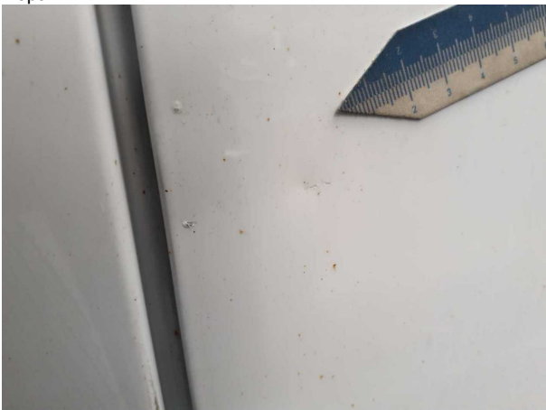
Beschädigung #5: Heckklappe/-tür: Hecktür rechts - Delle(n) - Smart Repair
