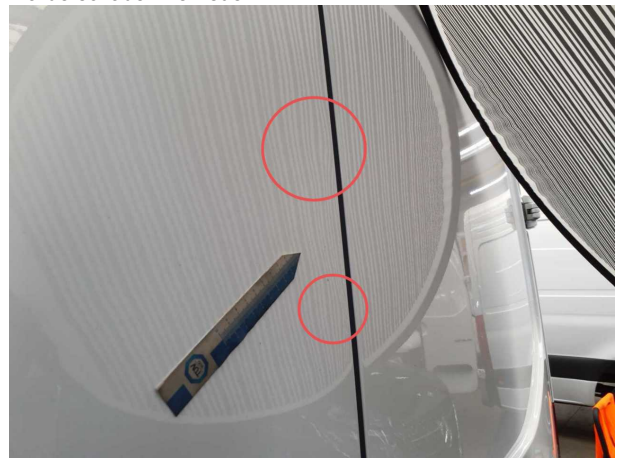
Beschädigung #3: Heckklappe/-tür: Hecktür links - Delle(n) - Sm... Repair
