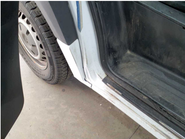
Beschädigung #6: Schweller links: Einstieg - Lackmangel - lackieren
