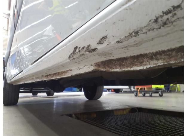
Beschädigung #8: Schweller rechts: Schweller - verformt - instandsetzen und lackieren
