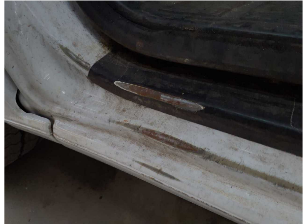
Beschädigung #6: Schweller links: Einstieg - Lackmangel - lackieren
