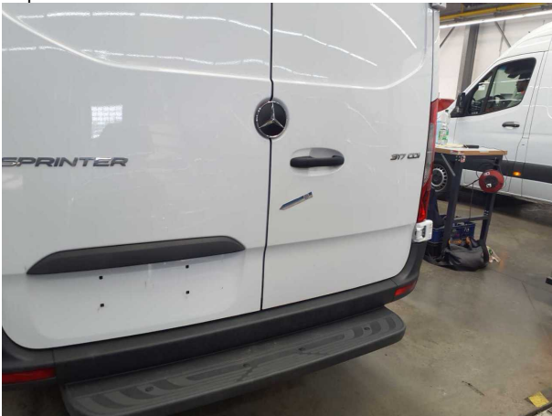
Beschädigung #5: Heckklappe/-tür: Hecktür rechts - Delle(n) - Smart Repair
