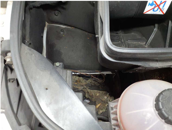
Beschädigung #2: Kotflügel rechts: Innenkotflügel - Marderschaden - erneuern
