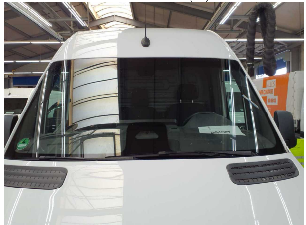
Beschädigung #11: Verglasung: Frontscheibe mit Spurhalteassistent - gebrochen / gerissen - erneuern
