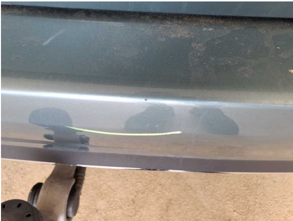
Beschädigung #3: Stossfänger hinten: Stossfänger hinten - verkratzt / verschürft - instandsetzen und lackieren
