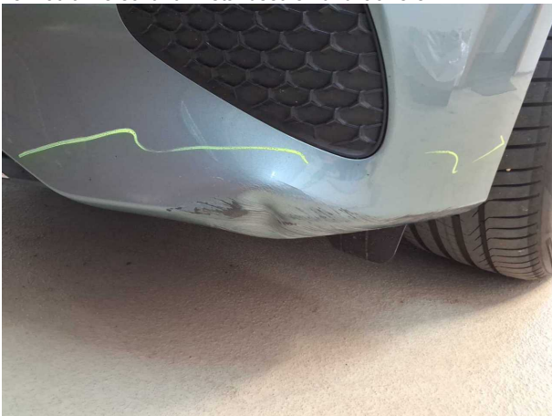
Beschädigung #4: Stossfänger vorn: Stossfänger vorn - verformt - erneuern
