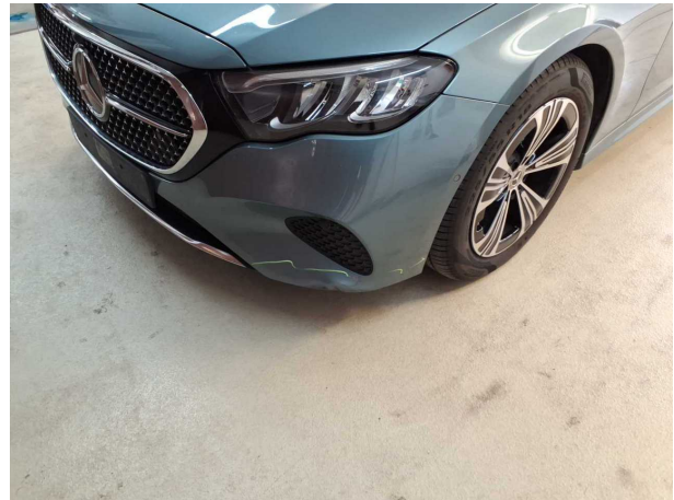
Beschädigung #4: Stossfänger vorn: Stossfänger vorn - verformt - erneuern
