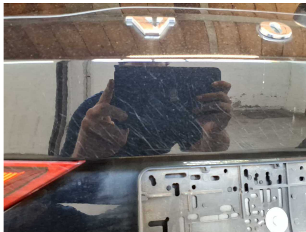
Beschädigung #1: Heckklappe/-tür: Heckklappe - verkratzt / verschürft - Smart Repair
