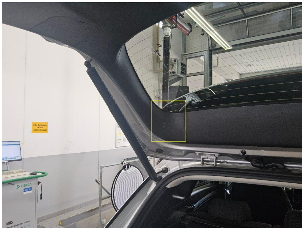
Bild 21 : Heckklappe Verkleidung links oben, zerkratzt
