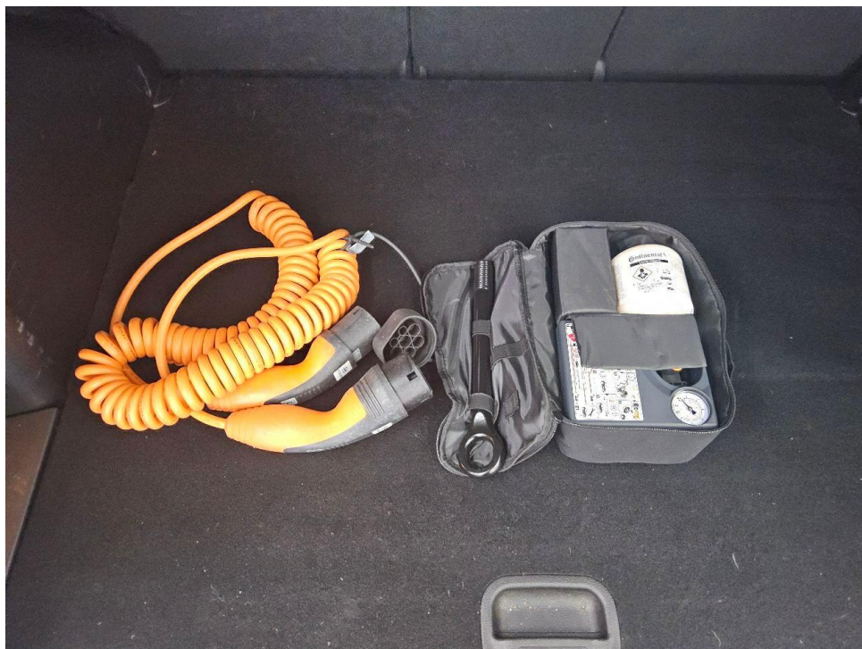
Bild 6 : Ladekabel beim E-Fahrzeug
