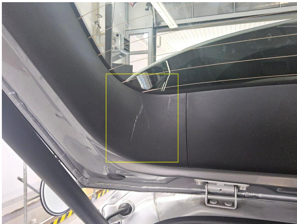
Bild 22 : Heckklappe Verkleidung links oben, zerkratzt
