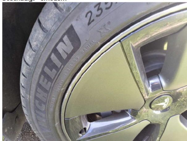
Beschädigung #12: Rad/Reifen: Leichtmetallfelge vorn rechts - beschädigt - erneuern
