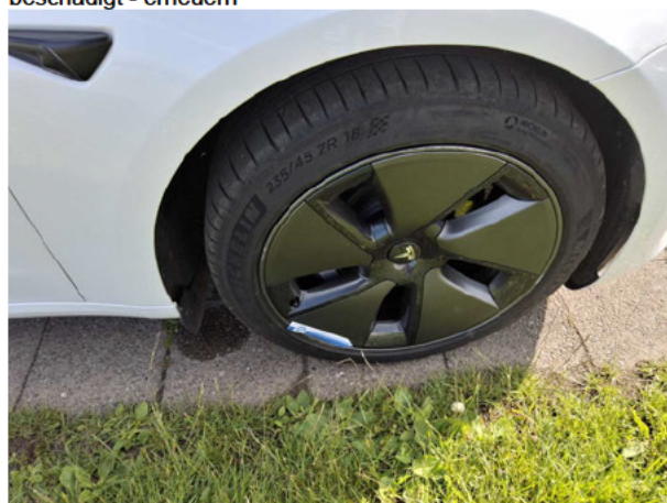
Beschädigung #12: Rad/Reifen: Leichtmetallfelge vorn rechts - beschädigt - erneuern
