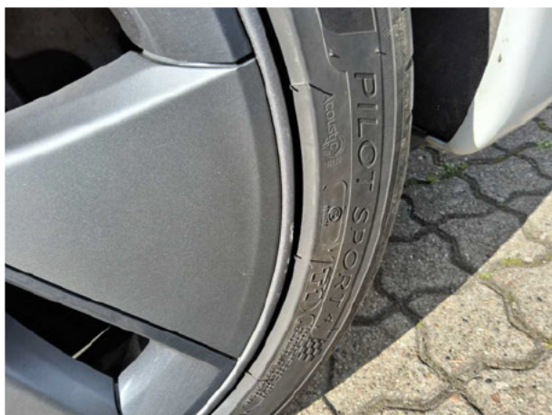
Beschädigung #9: Rad/Reifen: Leichtmetallfelge hinten links - beschädigt - erneuern
