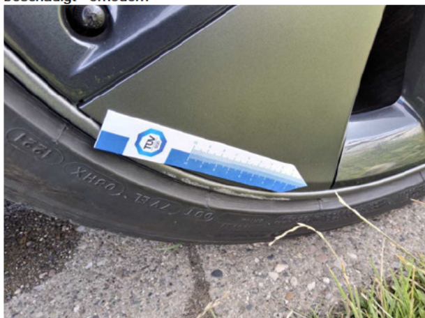
Beschädigung #12: Rad/Reifen: Leichtmetallfelge vorn rechts - beschädigt - erneuern
