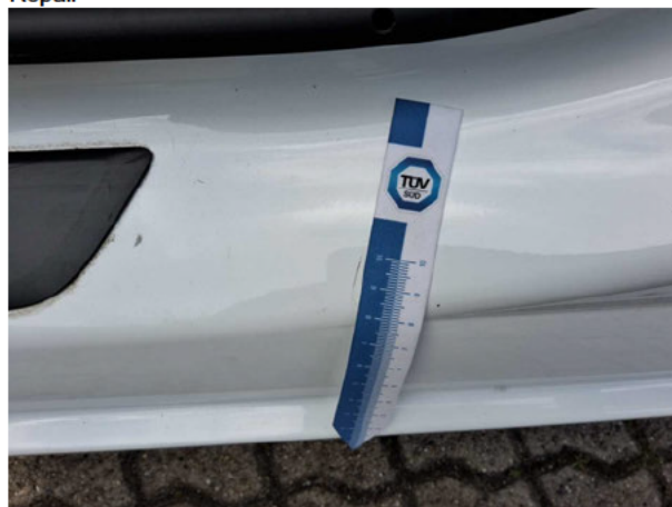
Beschädigung #6: Schweller links: Einstieg - Kratzer - Smart Repair
