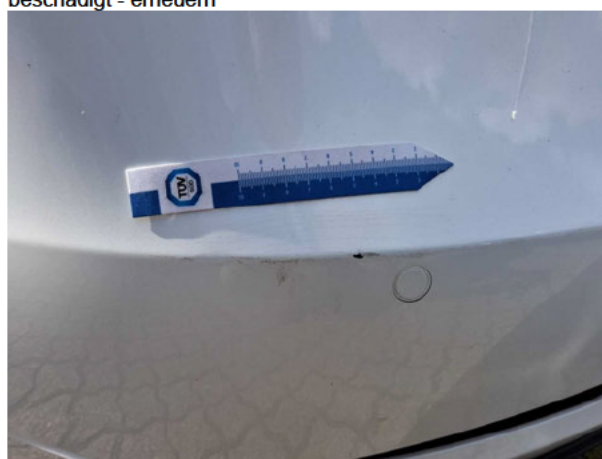
Beschädigung #13: Stossfänger hinten: Stossfänger hinten - Lackmangel - lackieren
