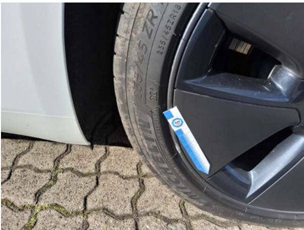
Beschädigung #9: Rad/Reifen: Leichtmetallfelge hinten links - beschädigt - erneuern
