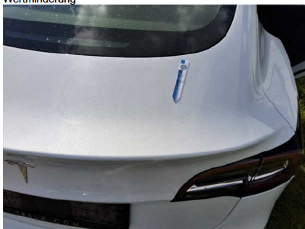
Beschädigung #5: Heckklappe/-tür: Heckklappe - Kratzer - Smart Repair
