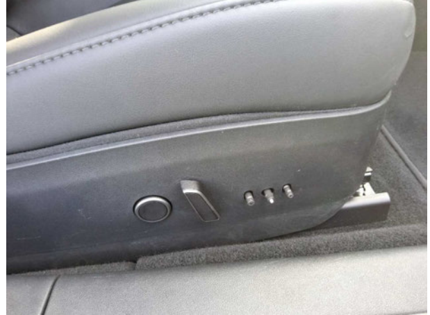
Beschädigung #1: Sitz vorn: Sitzverstellung rechts - fehlt - erneuern
