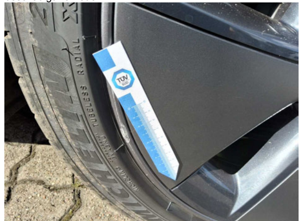
Beschädigung #9: Rad/Reifen: Leichtmetallfelge hinten links - beschädigt - erneuern
