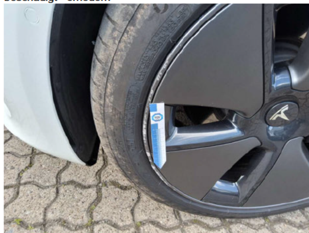
Beschädigung #11: Rad/Reifen: Leichtmetallfelge vorn links - beschädigt - erneuern
