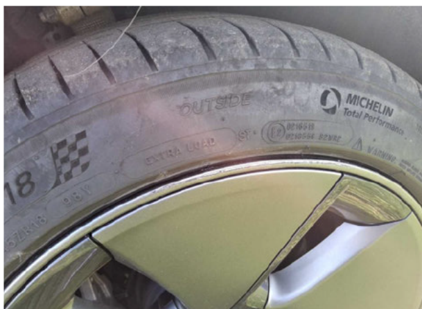
Beschädigung #12: Rad/Reifen: Leichtmetallfelge vorn rechts - beschädigt - erneuern
