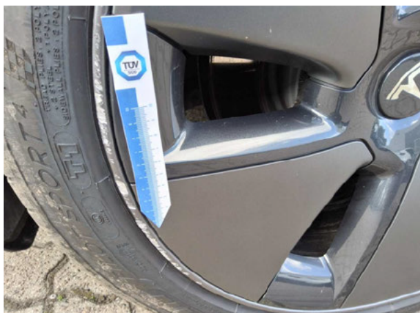
Beschädigung #11: Rad/Reifen: Leichtmetallfelge vorn links - beschädigt - erneuern
