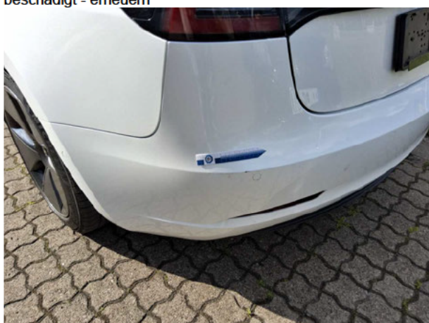
Beschädigung #13: Stossfänger hinten: Stossfänger hinten - Lackmangel - lackieren
