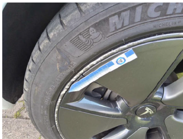
Beschädigung #10: Rad/Reifen: Leichtmetallfelge hinten rechts - beschädigt - erneuern
