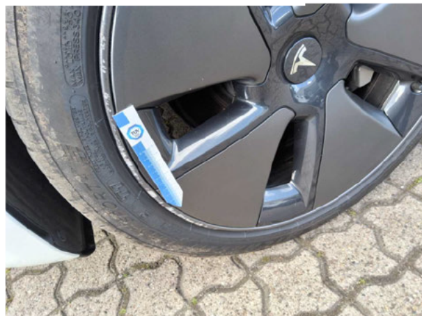
Beschädigung #11: Rad/Reifen: Leichtmetallfelge vorn links - beschädigt - erneuern
