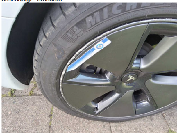
Beschädigung #10: Rad/Reifen: Leichtmetallfelge hinten rechts - beschädigt - erneuern
