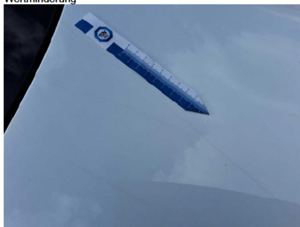
Beschädigung #5: Heckklappe/-tür: Heckklappe - Kratzer - Smart Repair
