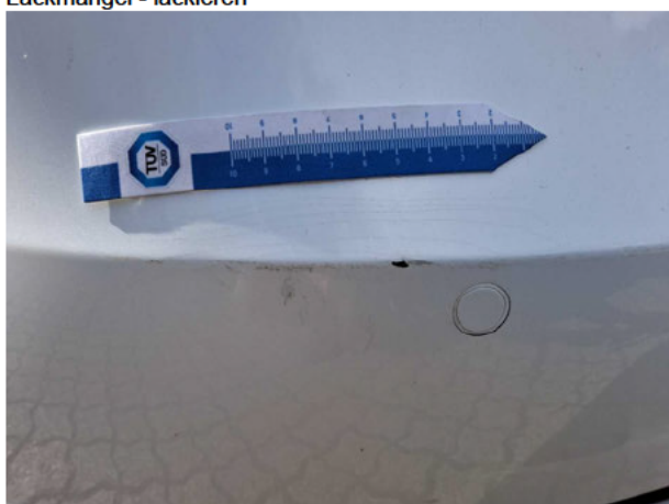
Beschädigung #13: Stossfänger hinten: Stossfänger hinten - Lackmangel - lackieren
