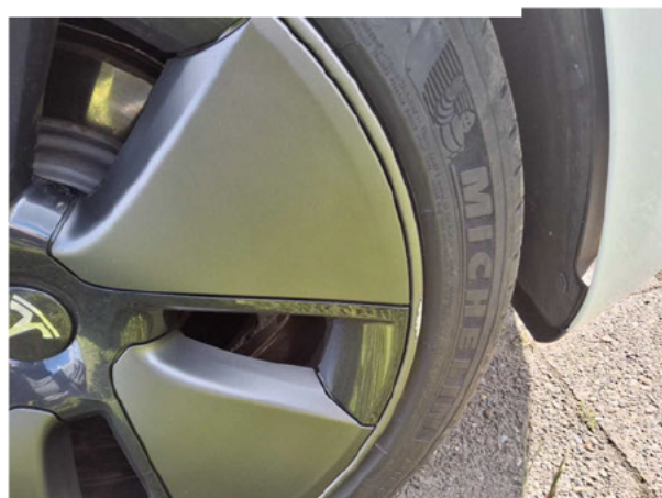
Beschädigung #12: Rad/Reifen: Leichtmetallfelge vorn rechts - beschädigt - erneuern
