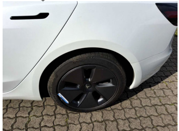
Beschädigung #9: Rad/Reifen: Leichtmetallfelge hinten links - beschädigt - erneuern
