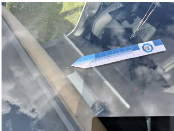
Beschädigung #14: Verglasung: Frontscheibe - Steinschlag - instandsetzen
