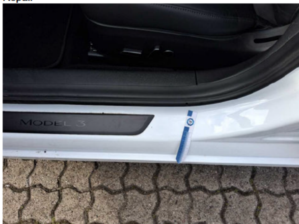
Beschädigung #6: Schweller links: Einstieg - Kratzer - Smart Repair
