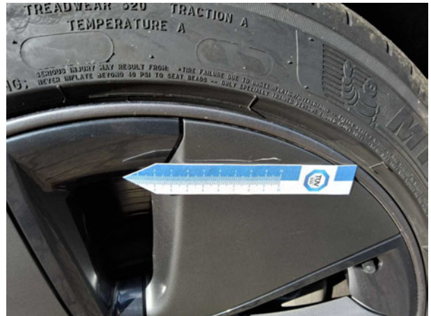
Beschädigung #2: Rad/Reifen: Radblende hinten links - Kratzer - erneuern
