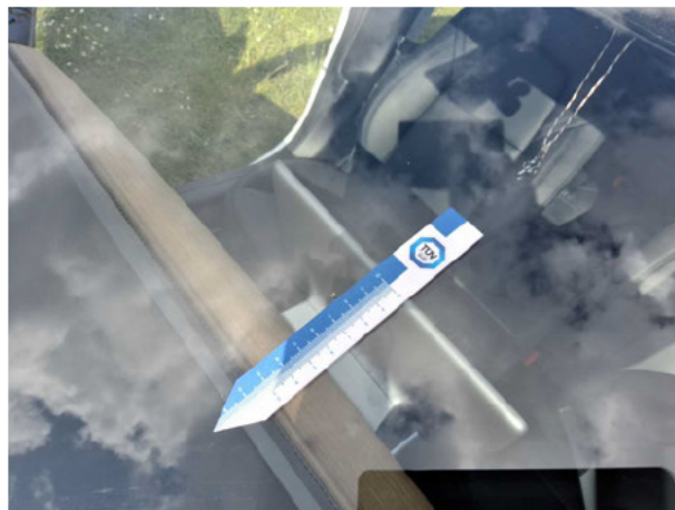
Beschädigung #14: Verglasung: Frontscheibe - Steinschlag - instandsetzen
