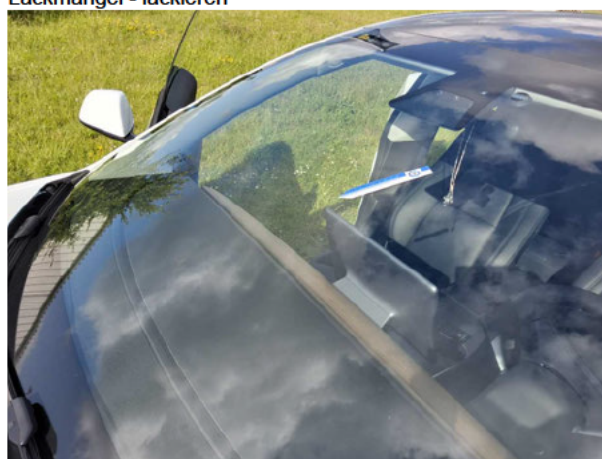
Beschädigung #14: Verglasung: Frontscheibe - Steinschlag - instandsetzen
