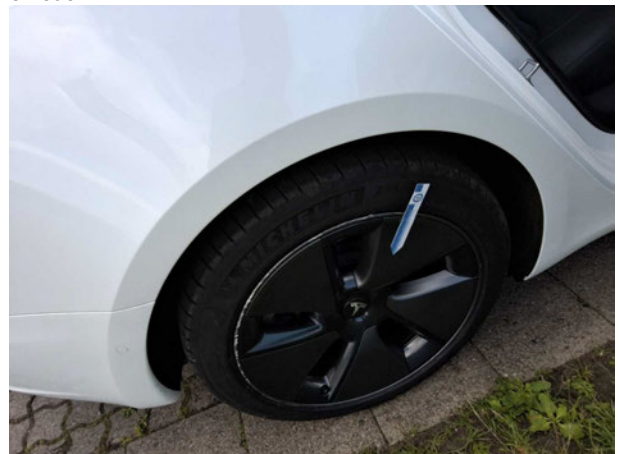
Beschädigung #3: Rad/Reifen: Radblende hinten rechts - Kratze... erneuern
