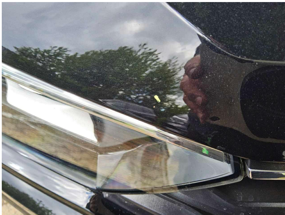
Bild 19 : Steinschläge auf der Motorhaube
