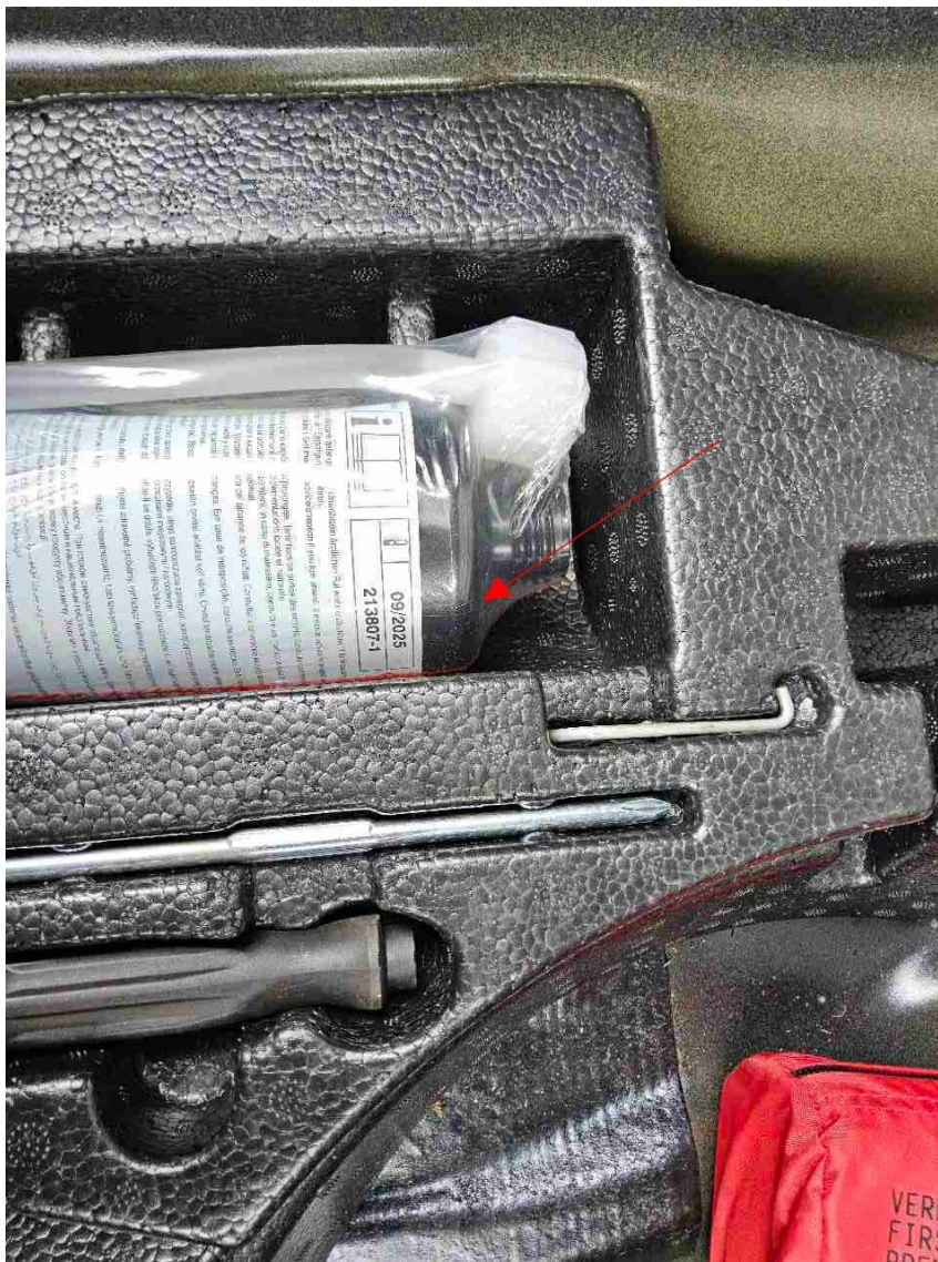
Bild 21 : Reifendichtmittel ist abgelaufen
