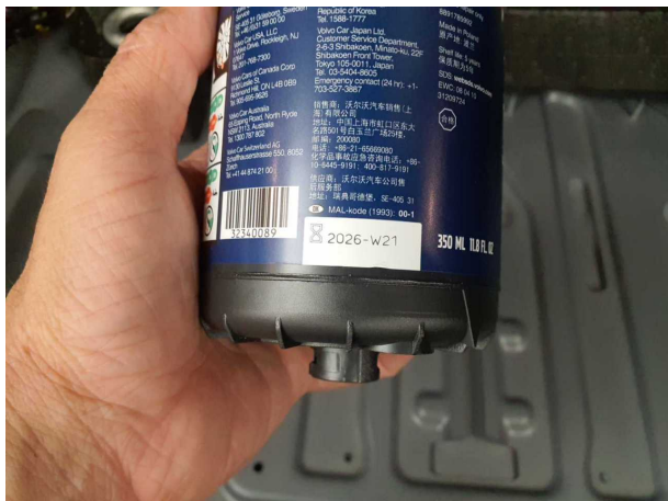
Beschädigung #1: Ausrüstung: Tirefit Füllmittel - abgelaufen - erneuern
