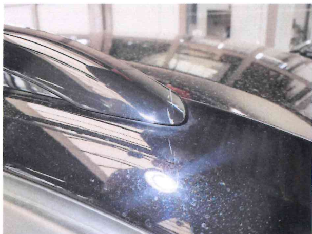
Beschädigung 2: Karosserie: Karosserie (Washstraßenschaden, KV notwendig, Kosten geschätzt) - beschädigt - instandsetzen
