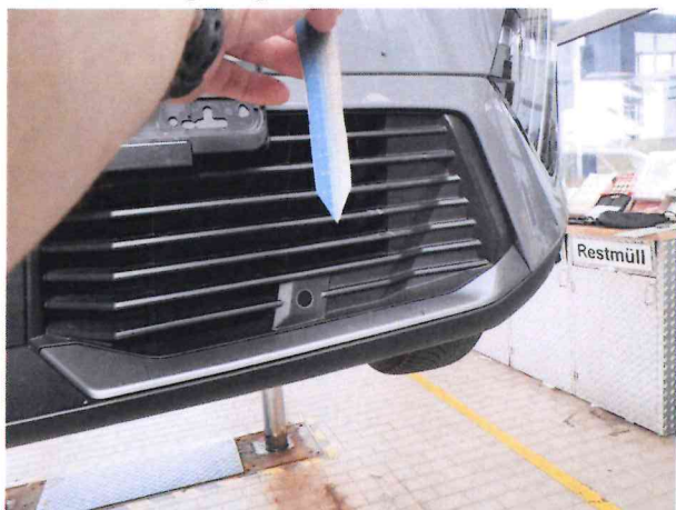
Beschädigung 1: Stossfänger vorn: Lufteinlassgitter (Gitter und Zierleiste) - verkratzt / verschürft - erneuern
