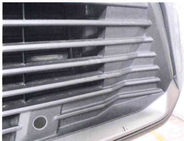
Beschädigung 1: Stossfänger vorn: Lufteinlassgitter (Gitter und Zierleiste) - verkratzt / verschürft - erneuern
