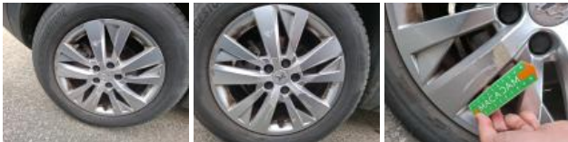
Alloy rim RR, Scratch(es), Repair/replace (lump sum)
