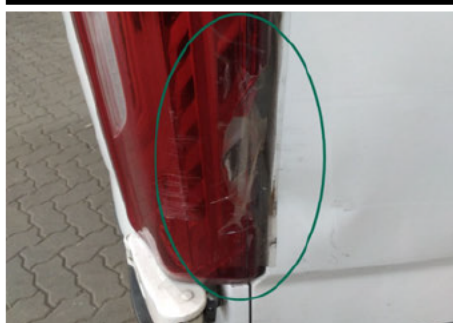
Heckleuchte / Hinten Rechts / Gebrochen
