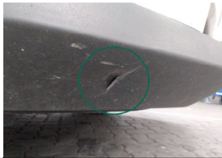
Stoßfänger unterhalb / Vorne / Gebrochen
