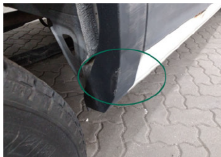
Kotflügelzwerleiste / Hinten Rechts / Kratzer
