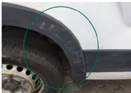
Kotflügelzwerleiste / Hinten Rechts / Kratzer
