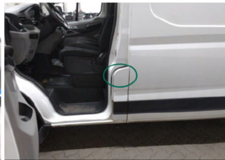
Tankdeckel / Vorne Links / Delle
