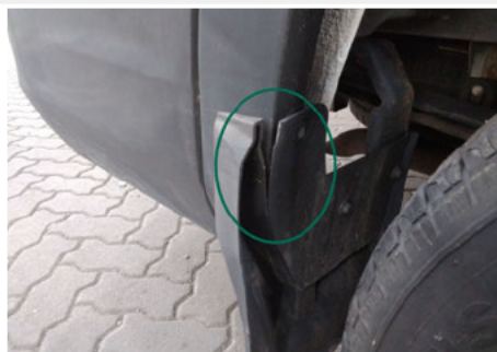
Spritzschutz / Hinten Rechts / Gebrochen
