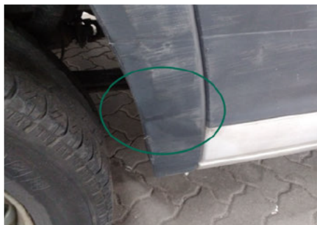
Kotflügelzwerleiste / Hinten Rechts / Kratzer
