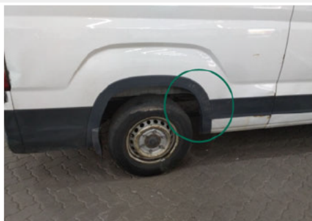
Kotflügelzwerleiste / Hinten Rechts / Kratzer
