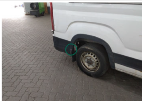
Spritzschutz / Hinten Rechts / Gebrochen
