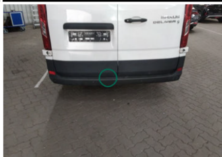
Stoßfänger / Hinten / Gebrochen
