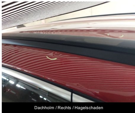
Dachholm / Rechts / Hagelschaden
