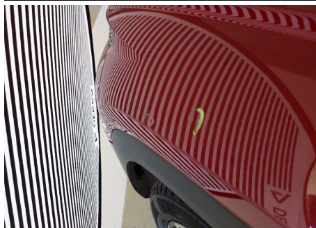
Kotflügel / Vorne Links / Hagelschaden
