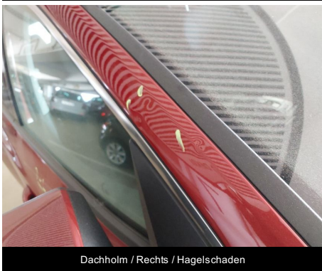
Dachholm / Rechts / Hagelschaden
