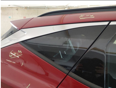
Zierleiste Fensterrahmen / Hinten Rechts / Delle
