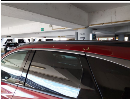
Dachholm / Links / Hagelschaden
