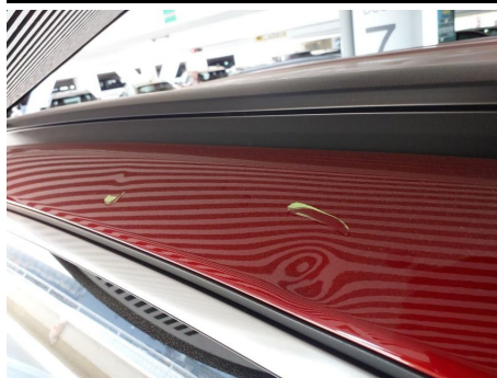
Dachholm / Links / Hagelschaden
