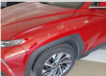
Kotflügel / Vorne Links / Hagelschaden
