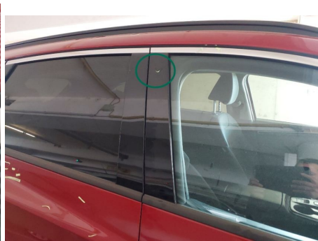
B-Säule außen / Rechts / Delle
