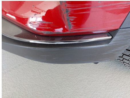
Stoßfängerleiste / Vorne / Kratzer
