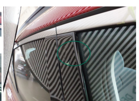
B-Säule außen / Rechts / Delle
