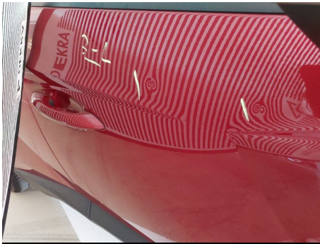
Tür / Vorne Rechts / Hagelschaden
