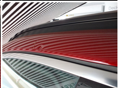
Dachholm / Links / Hagelschaden
