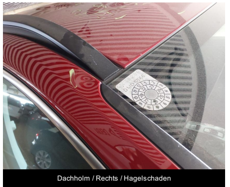
Dachholm / Rechts / Hagelschaden
