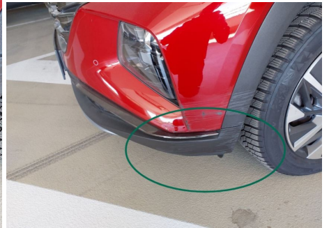
Stoßfänger Spoiler / Vorne / Kratzer
