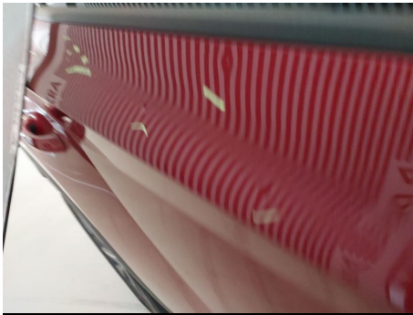
Tür / Hinten Rechts / Hagelschaden
