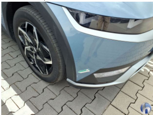
9. Radlaufbelende re.vo. Abschürfung - Smart Repair
