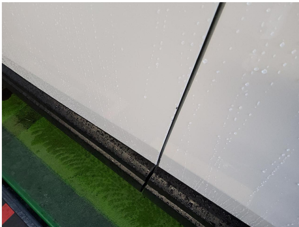
Bild 18 : Tür vorne links Lackierung, zerkratzt, Gebrauchsspur
