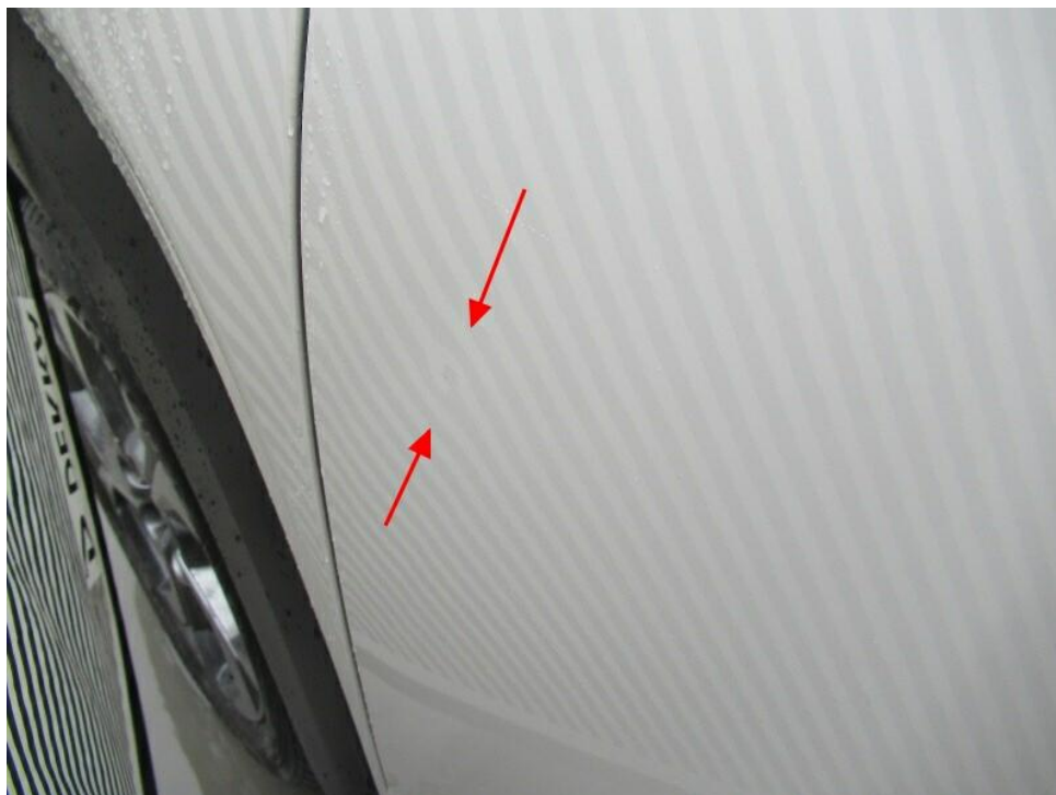
Bild 20 : Tür hinten rechts, eingedellt, Gebrauchsspur
