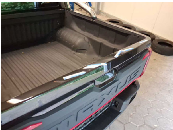
Beschädigung #1: Heckklappe/-tür: Heckklappe - Delle / Lackschaden - instandsetzen und lackieren
