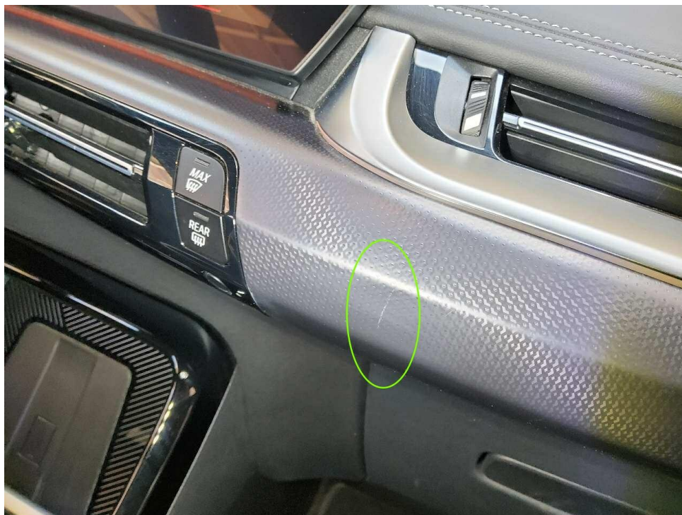
Bild 17 : Blende Armaturenbrett rechts mehrfach verkratzt
