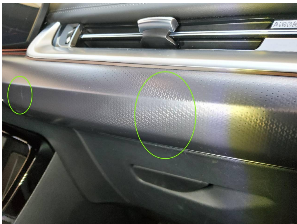
Bild 16 : Blende Armaturenbrett rechts mehrfach verkratzt
