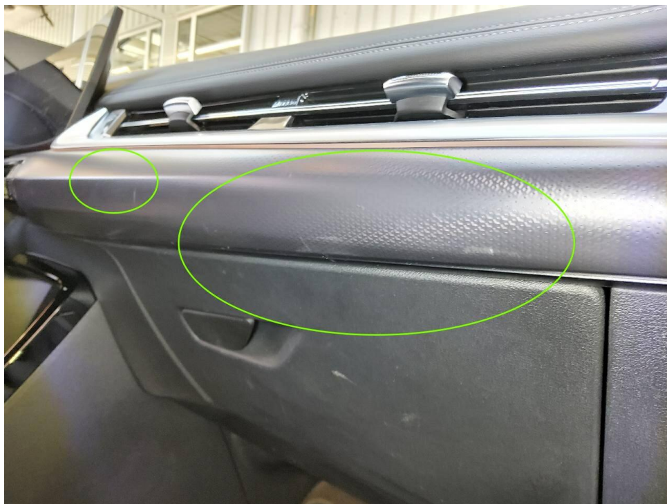
Bild 15 : Blende Armaturenbrett rechts mehrfach verkratzt
