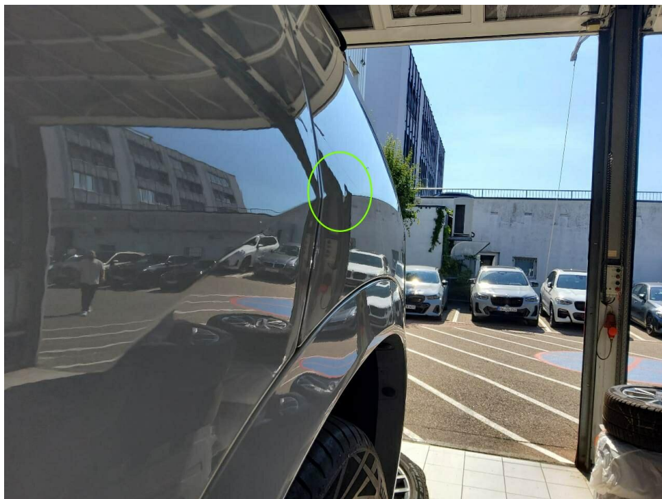
Bild 24 : Seitenwand hinten links eingedellt mit Lackbeschädigung
