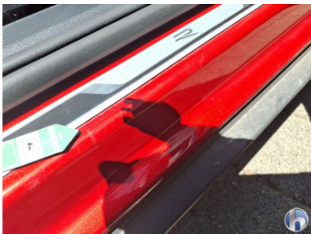
10. Türeinstieg rechts vorn Kratzer - Smart Repair
