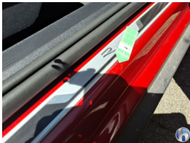
10. Türeinstieg rechts vorn Kratzer - Smart Repair
