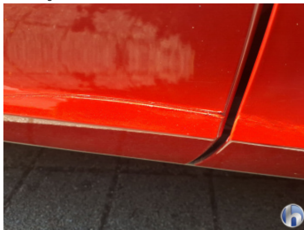
11. Türverkleidung re.hi. Beschädigt - Erneuern
