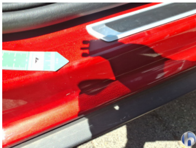
10. Türeinstieg rechts vorn Kratzer - Smart Repair
