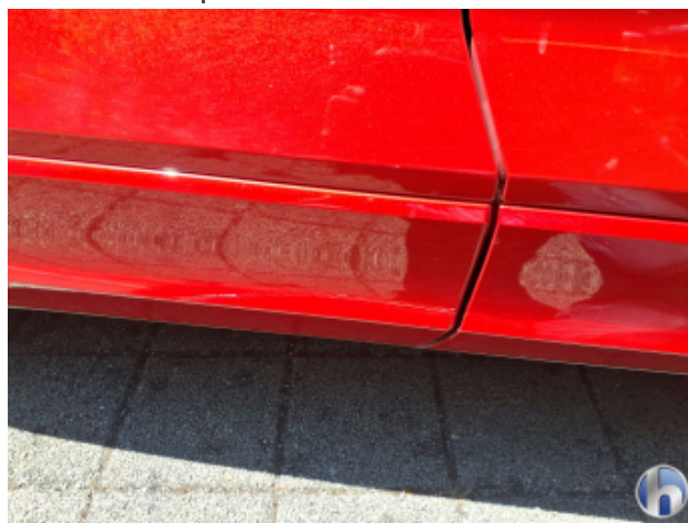
11. Türverkleidung re.hi. Beschädigt - Erneuern
