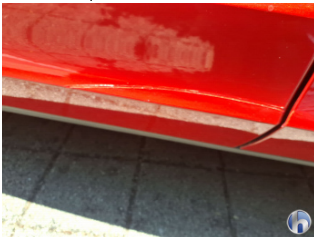
11. Türverkleidung re.hi. Beschädigt - Erneuern
