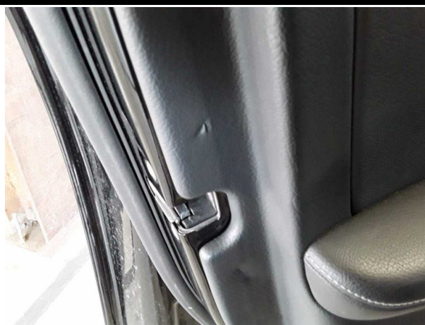
Beschädigung #7: Verkleidungen/Abdeckungen: Türverkleidung vorn links - beschädigt - erneuern
