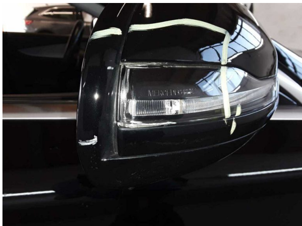
Beschädigung #3: Blinkleuchte: Spiegel rechts - verkratzt / verschürft - erneuern
