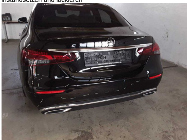
Beschädigung #9: Stossfänger hinten: Stossfänger mit Parktroni... verkratzt / verschürft - instandsetzen und lackieren
