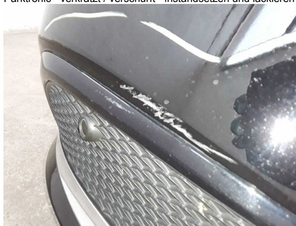
Beschädigung #10: Stossfänger vorn: Stossfänger mit Parktronic - verkratzt / verschürft - instandsetzen und lackieren
