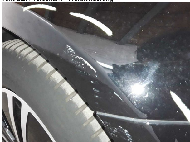
Beschädigung #5: Kotflügel rechts: Kotflügel rechts - verkratzt / verschürft - Smart Repair
