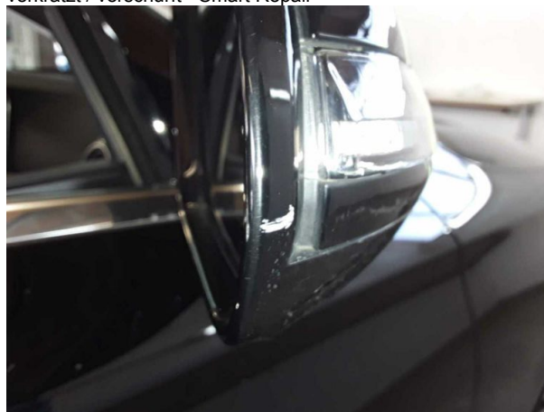
Beschädigung #6: Außenspiegel rechts: Spiegelgehäuse - verkratzt / verschürft - Smart Repair
