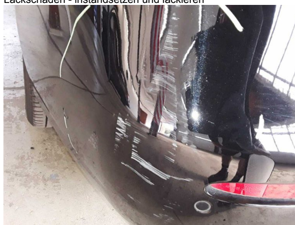
Beschädigung #9: Stossfänger hinten: Stossfänger mit Parktronic - verkratzt / verschürft - instandsetzen und lackieren
