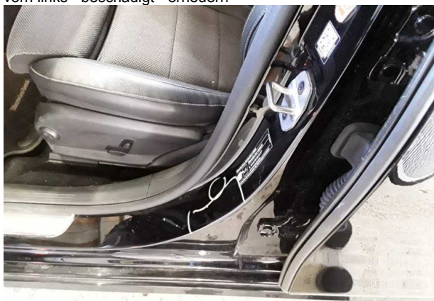
Beschädigung #7: Verkleidungen/Abdeckungen: Türverkleidung vorn links - beschädigt - erneuern
