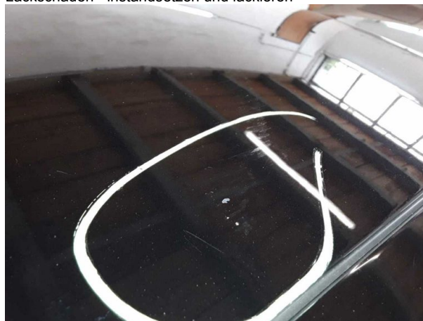
Beschädigung #11: Fahrzeugdach: Dach - Delle / Lackschaden - instandsetzen und lackieren
