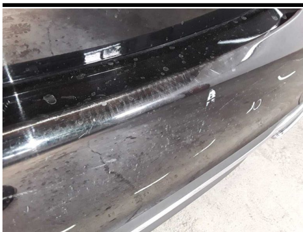
Beschädigung #9: Stossfänger hinten: Stossfänger mit Parktroni... verkratzt / verschürft - instandsetzen und lackieren
