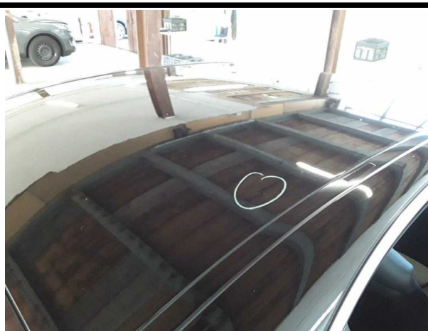
Beschädigung #11: Fahrzeugdach: Dach - Delle / Lackschaden - instandsetzen und lackieren
