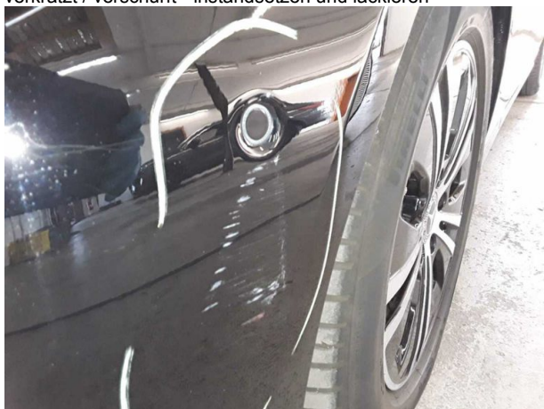
Beschädigung #10: Stossfänger vorn: Stossfänger mit Parktroni... verkratzt / verschürft - instandsetzen und lackieren
