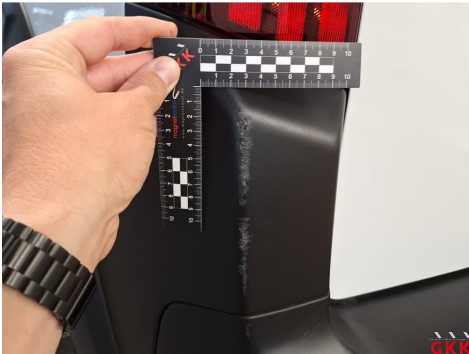
Bild 18 Stoßfänger hinten, Ecke links -unlackiert-, verkratzt, ersetzen
