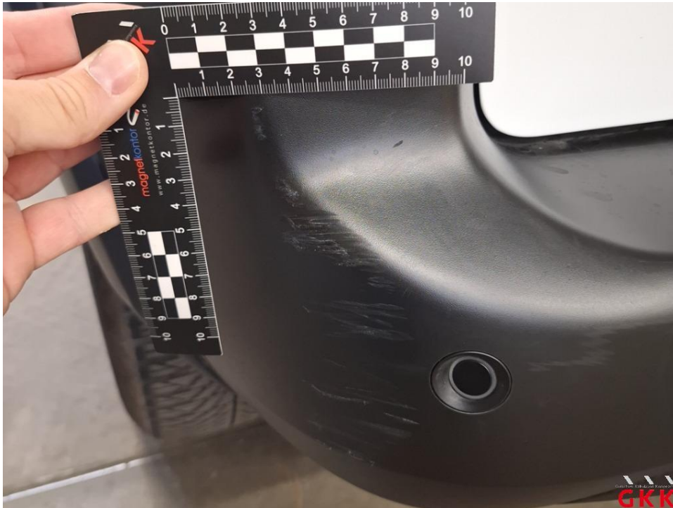
Bild 17 Stoßfänger hinten, Verkleidung -unlackiert-, verkratzt, ersetzen
