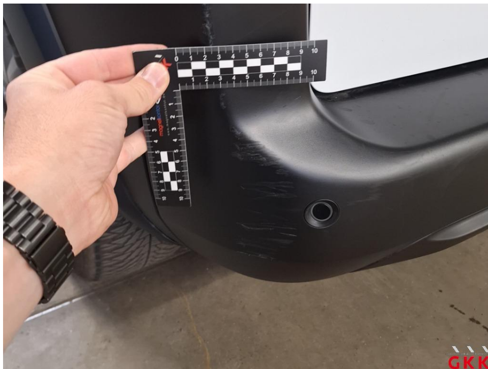
Bild 16 Stoßfänger hinten, Verkleidung -unlackiert-, verkratzt, ersetzen
