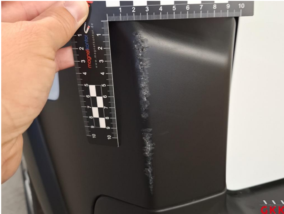
Bild 19 Stoßfänger hinten, Ecke links -unlackiert-, verkratzt, ersetzen
