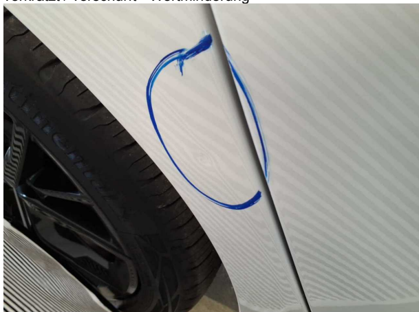
Beschädigung #2: Seitenwand rechts: Seitenwand - Delle(n) - Smart Repair
