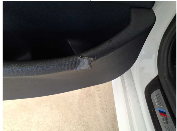
Beschädigung #5: Verkleidungen/Abdeckungen: Türverkleidung hinten links - beschädigt - erneuern
