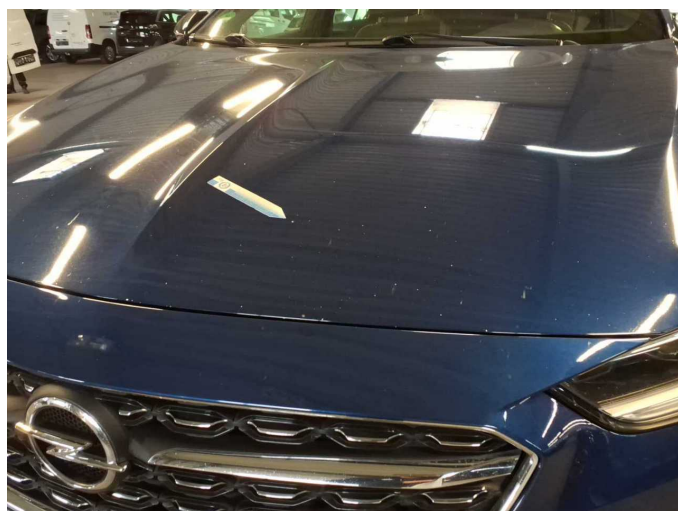
Damage 11: Bonnet: Bonnet (Sandstrahleffekt) - Stone chips - Paint
