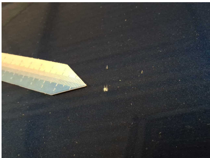
Damage 11: Bonnet: Bonnet (Sandstrahleffekt) - Stone chips - Paint
