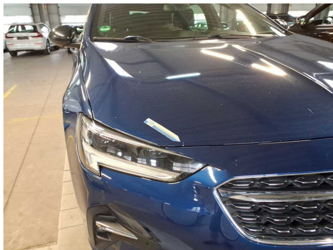
Damage 11: Bonnet: Bonnet (Sandstrahleffekt) - Stone chips - Paint
