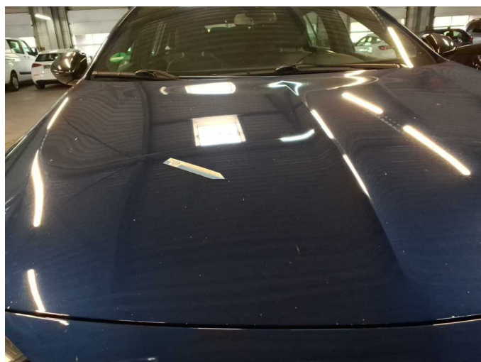
Damage 11: Bonnet: Bonnet (Sandstrahleffekt) - Stone chips - Paint
