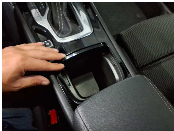
Damage 8: Instrument panel: Centre console - front (Ablagefachdeckel schließt nicht) - Malposition - Replace
