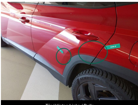
Tür / Hinten Links / Delle
