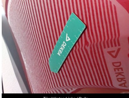
Tür / Hinten Links / Delle
