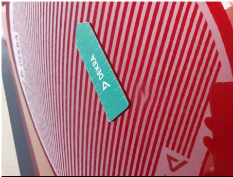
Tür / Vorne Links / Delle
