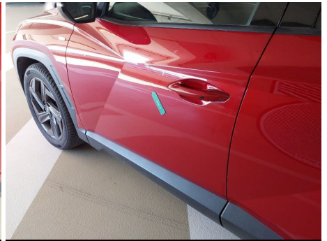
Tür / Vorne Links / Delle
