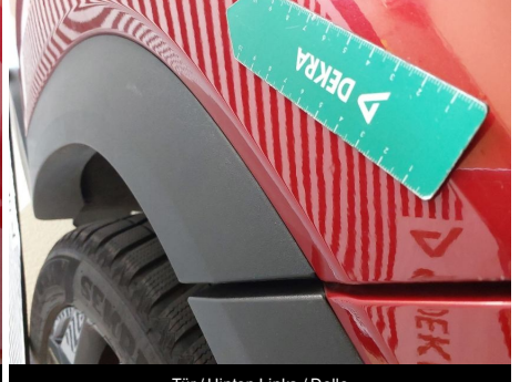
Tür / Hinten Links / Delle
