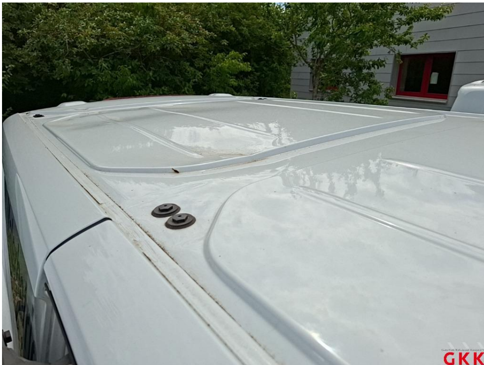
Bild 16 Dach, hinten, beschädigt, instand setzen - lackieren
