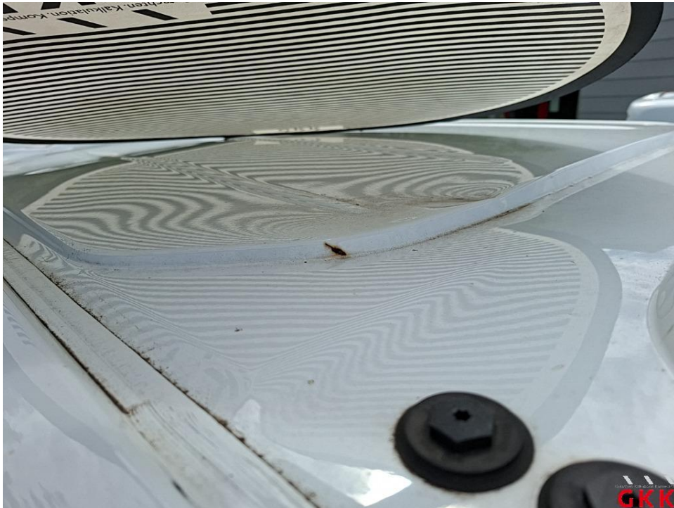
Bild 17 Dach, hinten, beschädigt, instand setzen - lackieren
