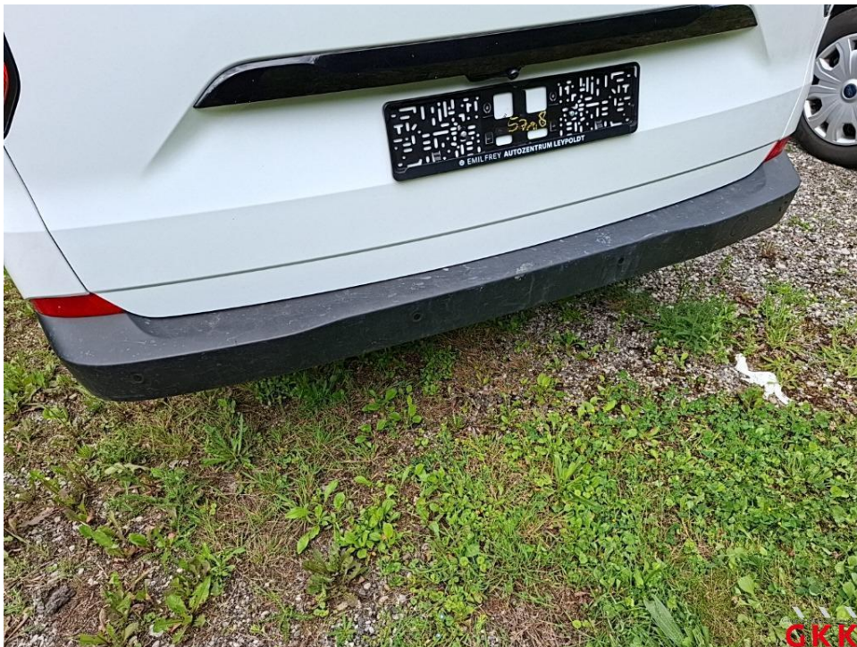
Bild 40 Stoßfänger hinten, Verkleidung -unlackiert-, beschädigt, ersetzen
