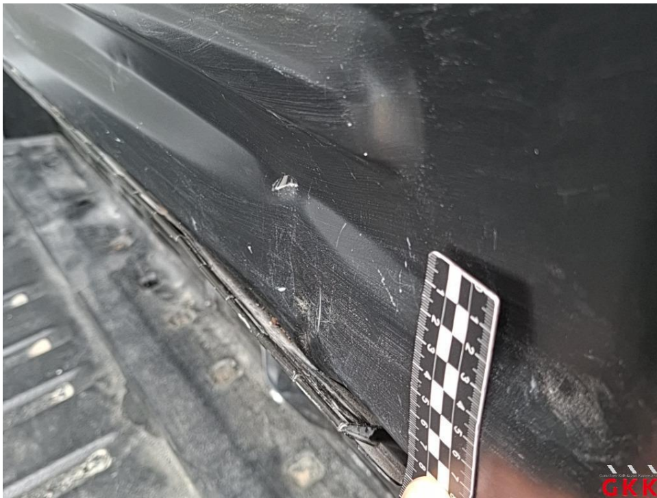
Bild 38 Trennwand, beschädigt, ersetzen
