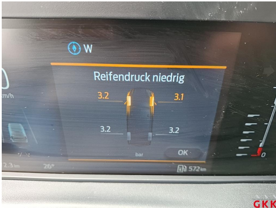
Bild 15 Kombiinstrument, Reifendruckkontrolle, aktiv, prüfen
