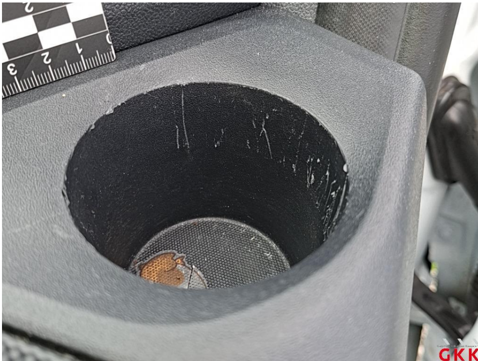
Bild 32 Armaturenbrett, Blende, verkratzt, ersetzen
