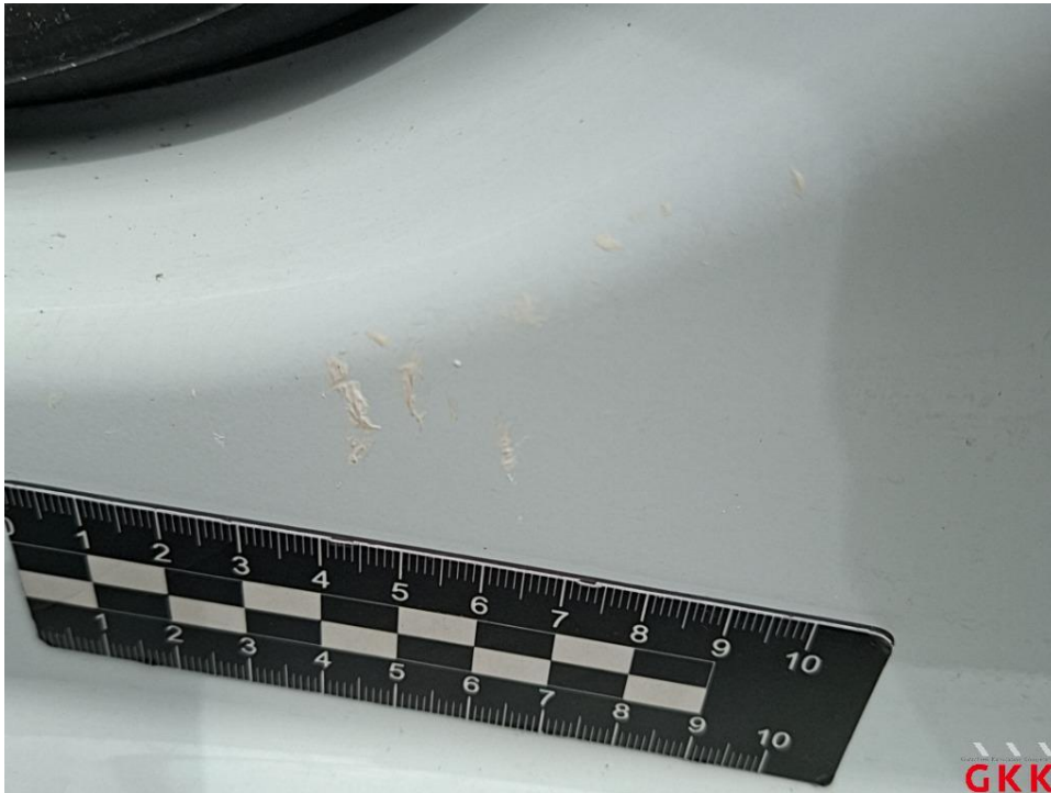
Bild 25 Farbanhaftung Tür vorne links, Einstieg, beschädigt, Smartrepair
