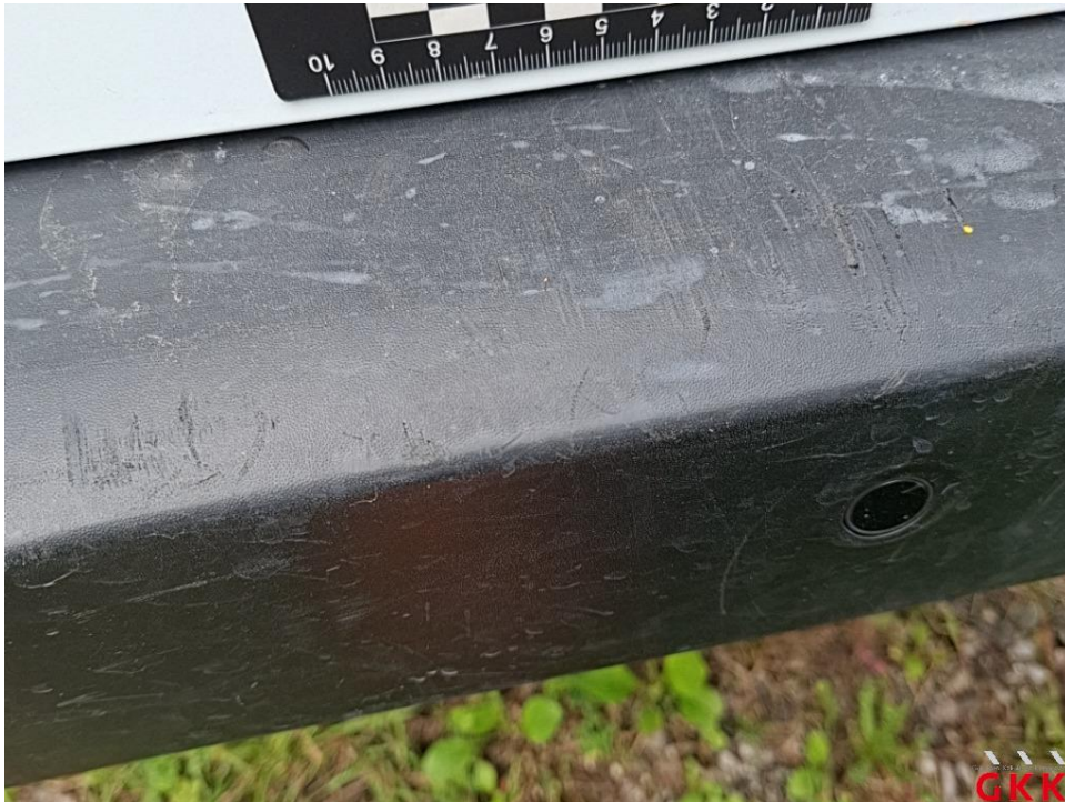
Bild 41 Stoßfänger hinten, Verkleidung -unlackiert-, beschädigt, ersetzen
