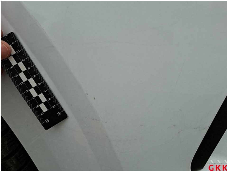
Bild 27 Stoßfänger vorne, Verkleidung oberhalb -lackiert-, verkratzt, auslegen, schleifen, polieren
