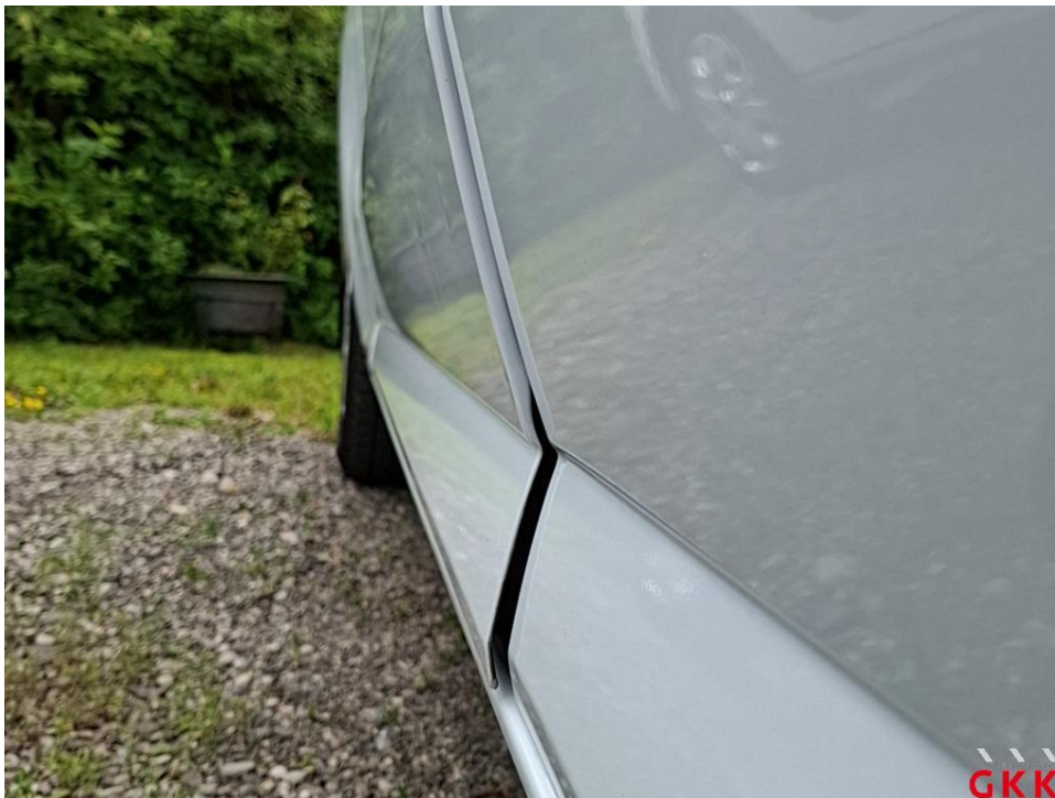
Bild 34 Schiebetür rechts, Spaltmaß fehlerhaft, instand setzen
