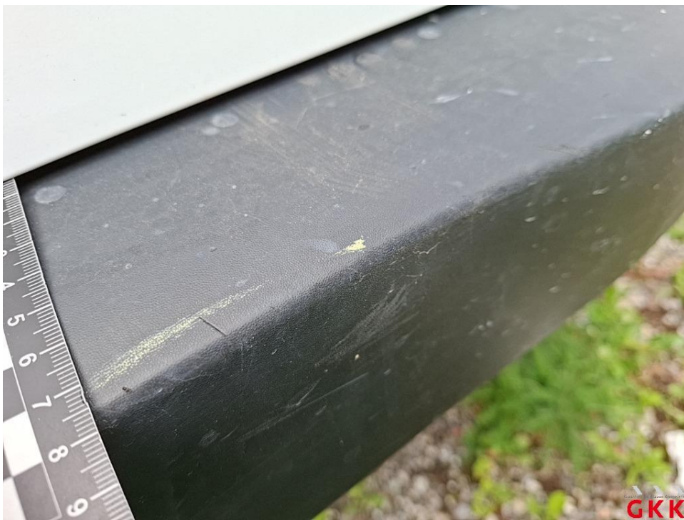
Bild 42 Stoßfänger hinten, Verkleidung -unlackiert-, beschädigt, ersetzen
