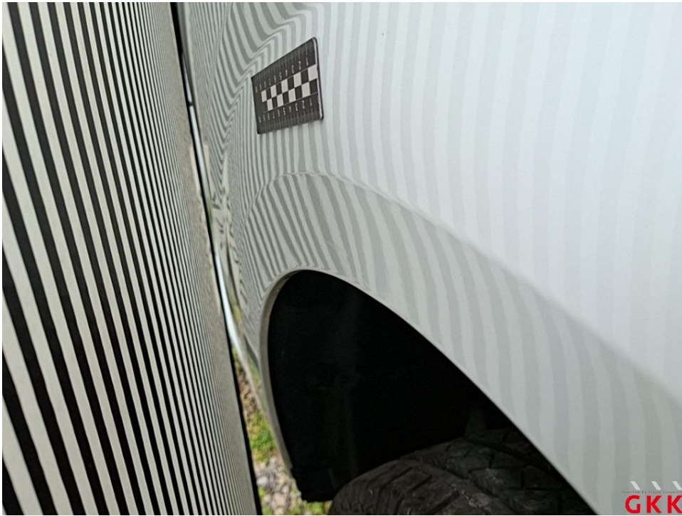
Bild 43 Seitenwand links, beschädigt, instand setzen - lackieren
