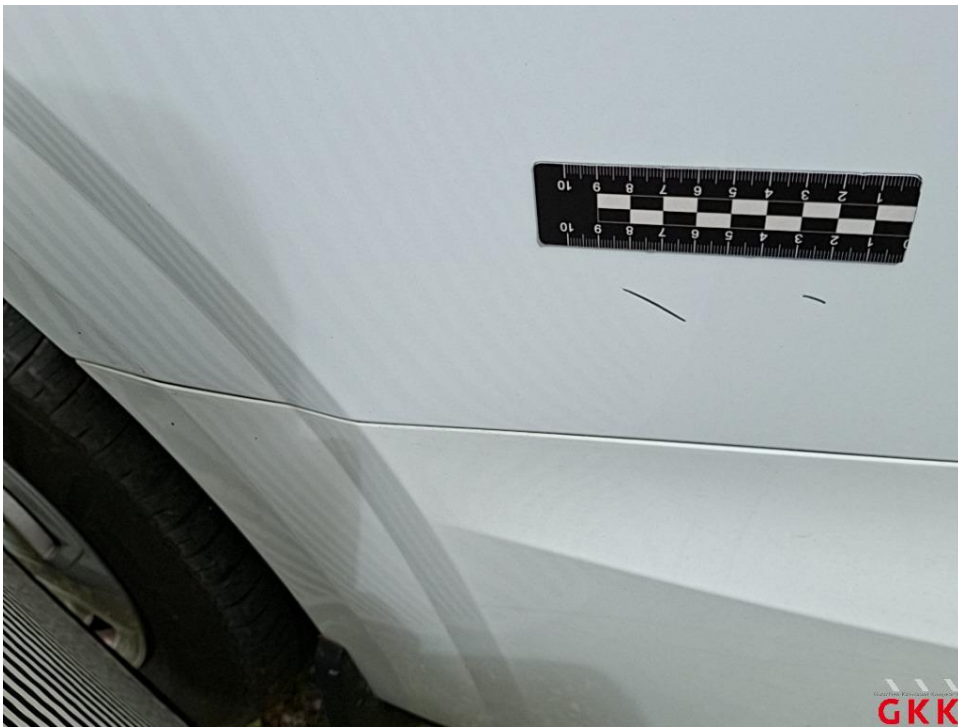
Bild 44 Seitenwand links, beschädigt, instand setzen - lackieren
