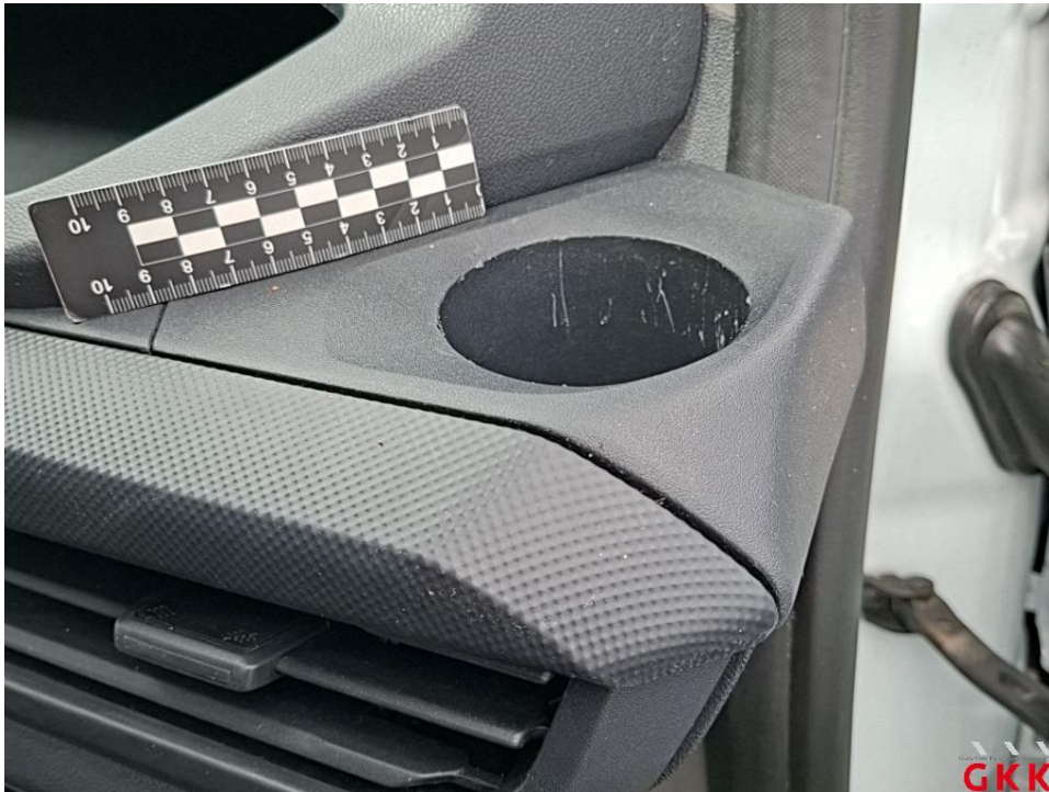
Bild 31 Armaturenbrett, Blende, verkratzt, ersetzen
