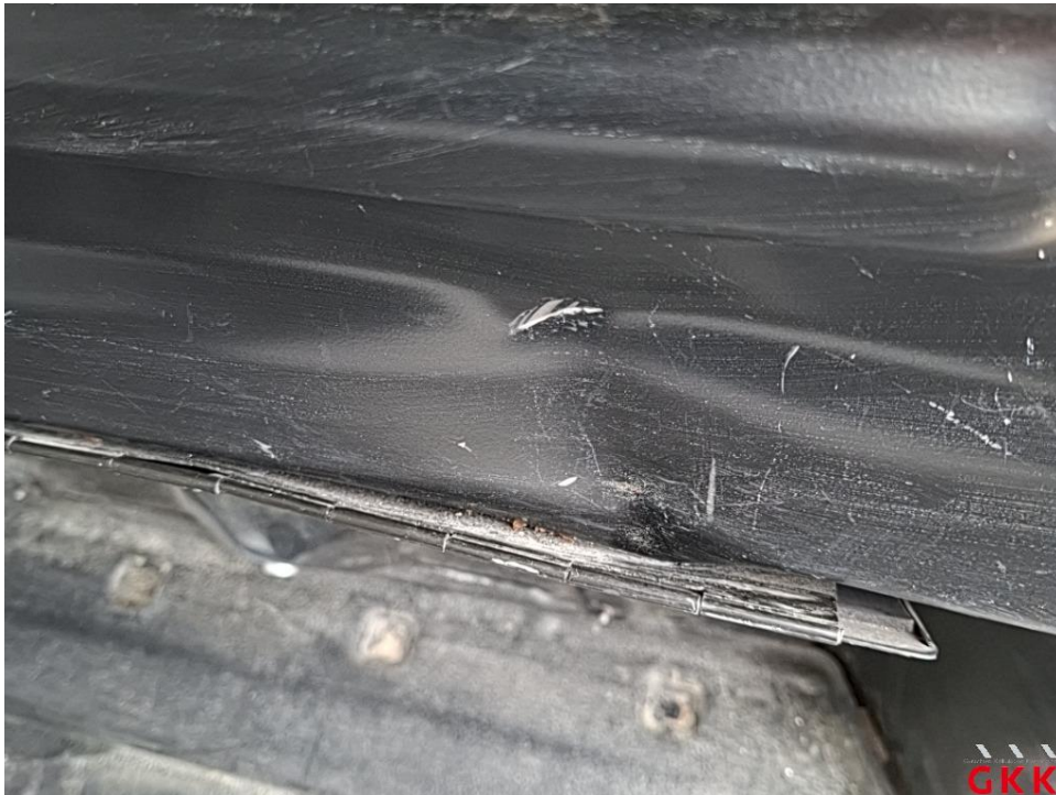
Bild 39 Trennwand, beschädigt, ersetzen
