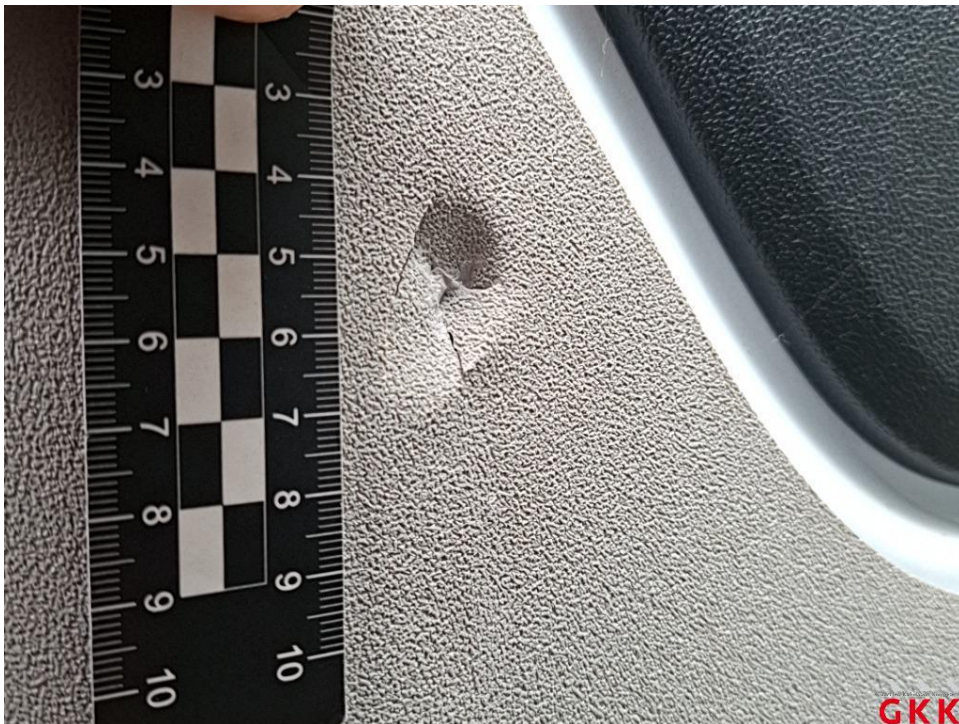
Bild 36 Schiebetür rechts, Innenverkleidung, beschädigt, ersetzen
