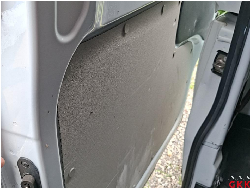
Bild 35 Schiebetür rechts, Innenverkleidung, beschädigt, ersetzen
