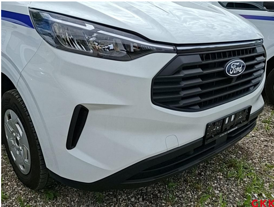
Bild 26 Stoßfänger vorne, Verkleidung oberhalb -lackiert-, verkratzt, auslegen, schleifen, polieren
