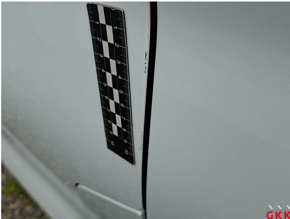
Bild 20 Tür vorne links, Kante, verkratzt, auslegen, schleifen, polieren
