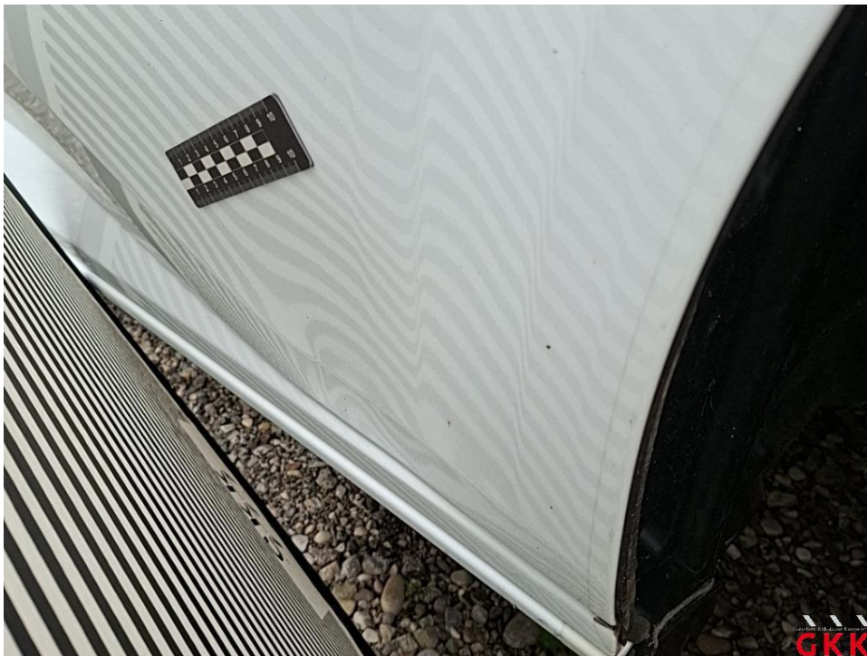
Bild 30 Tür vorne rechts, beschädigt, instand setzen - lackieren
