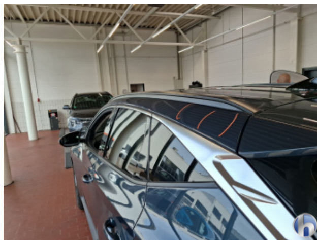
3. Dachrahmen - Links 2 Dellen - Sanft Instandsetzen
