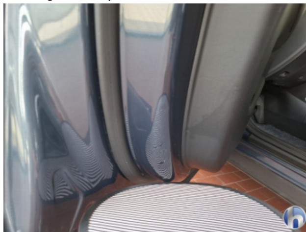
2. Tür Vorne - Links Beschädigt - Sanft Instandsetzen
