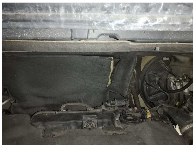
Damage 7: Misc.: Misc. (Stirnwand Dämmung) - Broken / torn - Replace
