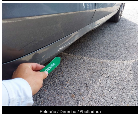
Peldaño / Derecha / Abolladura
