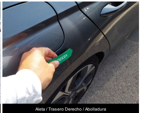
Aleta / Trasero Derecho / Abolladura
