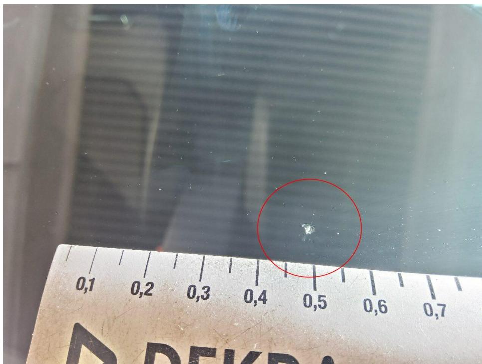
Bild 15 : Frontscheibe, Steinschlag mit Rissbildung
