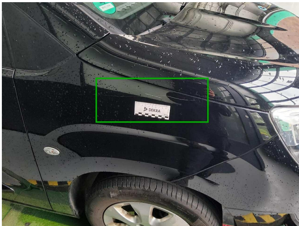
Bild 13 : Kotflügel vorne rechts Lackierung, zerkratzt, lackieren mit Lackaufbau
