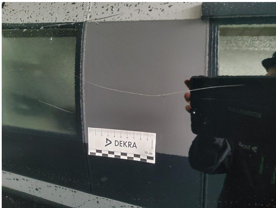
Bild 18 : Tür vorne rechts Lackierung, zerkratzt, lackieren mit Lackaufbau
