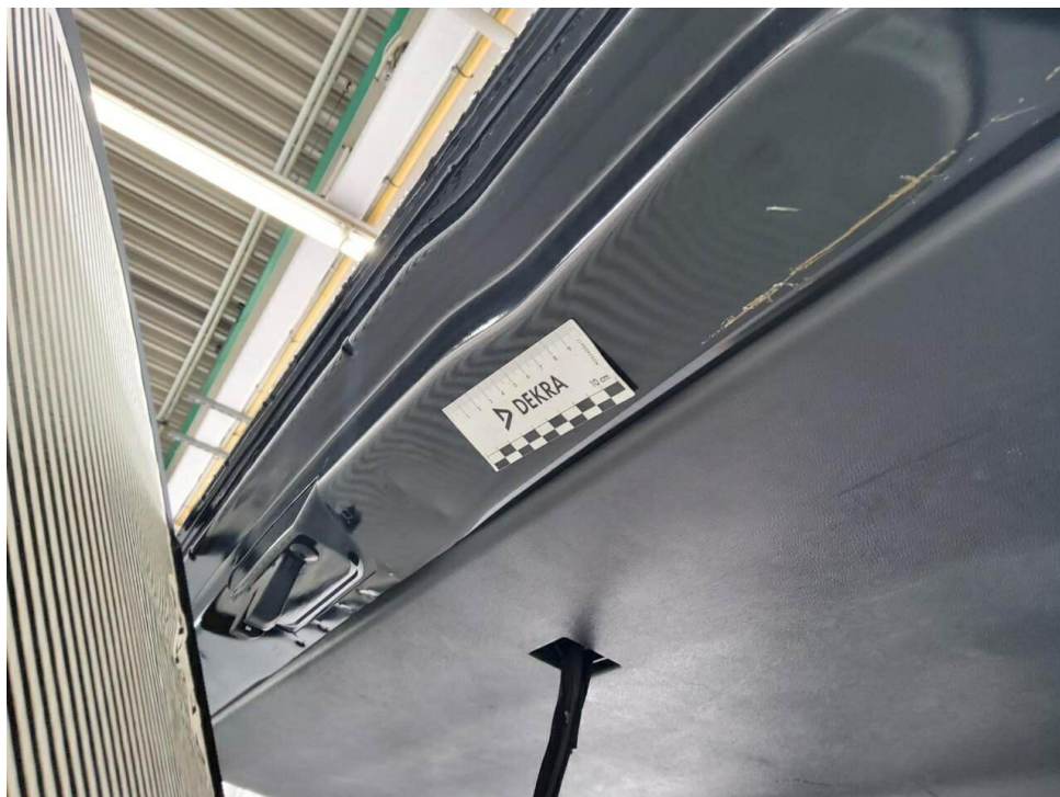
Bild 16 : Heckklappe, mehrfach eingedellt, Gebrauchsspur
