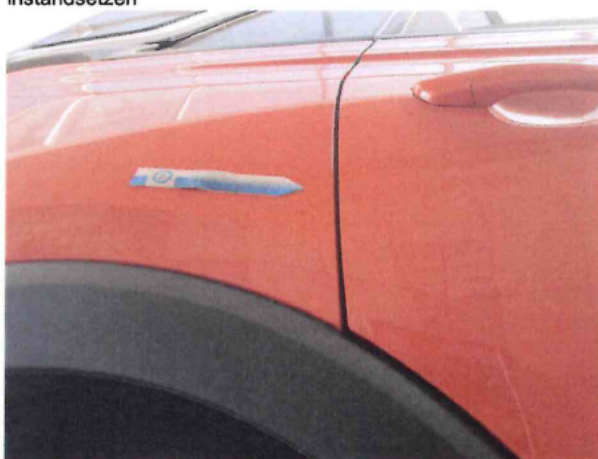
Beschädigung #10: Seitenwand rechts: Seitenwand - Delle(n) - sanft instandsetzen
