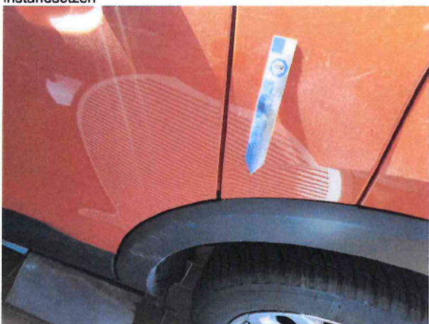
Beschädigung #8: Seitenwand links: Seitenwand - Delle(n) - sanft instandsetzen
