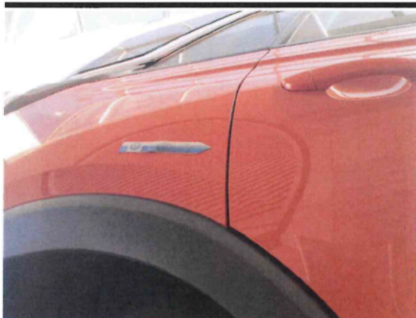
Beschädigung #10: Seitenwand rechts: Seitenwand - Delle(n) - sanft instandsetzen
