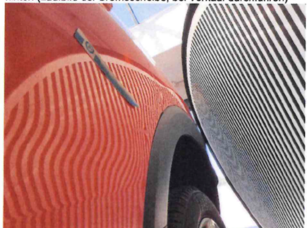
Beschädigung #15: Tür hinten links: Tür - Delle / Lackschad... - instandsetzen und lackieren
