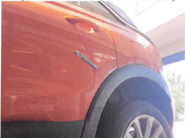
Beschädigung #15: Tür hinten links: Tür - Delle / Lackschaden - instandsetzen und lackieren
