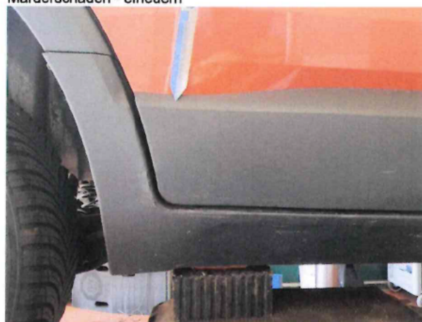
Beschädigung #6: Tür hinten rechts: Zierleiste unten - verkratzt / verschürft - Wertminderung
