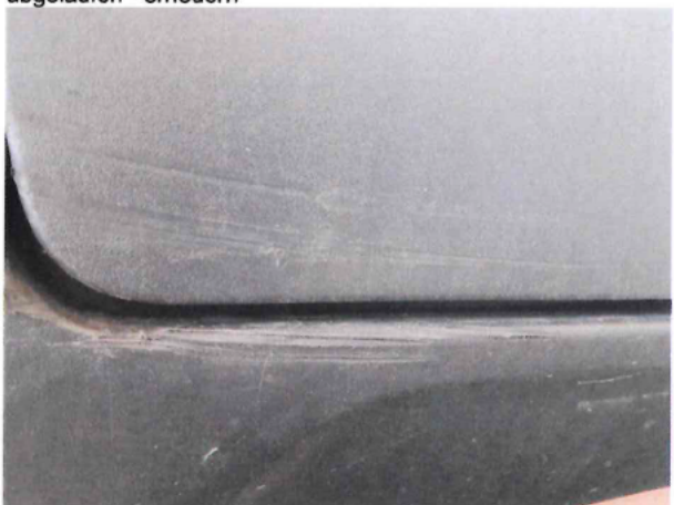
Beschädigung #6: Tür hinten rechts: Zierleiste unten - verkratzt / verschürft - Wertminderung
