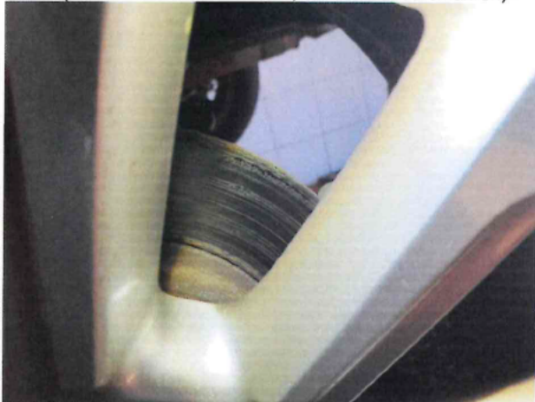
Beschädigung #14: Bremsanlage: Bremsscheiben und Beläge hinten (Laufbild der Bremsscheibe, bei Verkauf durchführen) -
