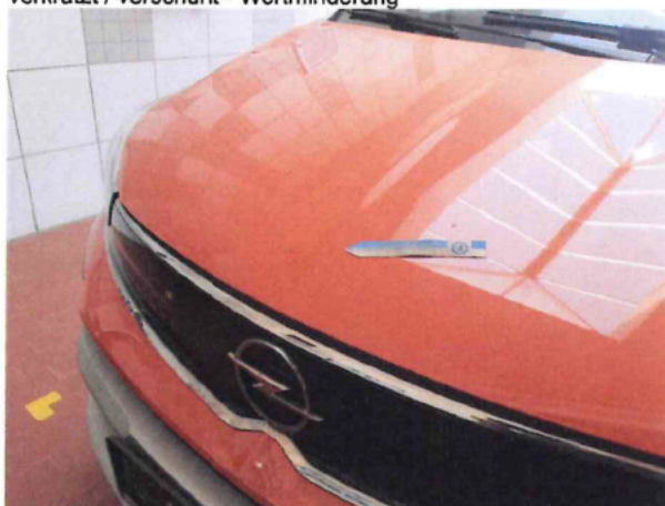
Beschädigung #7: Motorhaube: Motorhaube - Delle(n) - sanft instandsetzen
