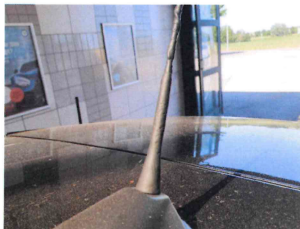
Beschädigung #4: Fahrzeugdach: Antennenstab - Marderschaden - erneuern
