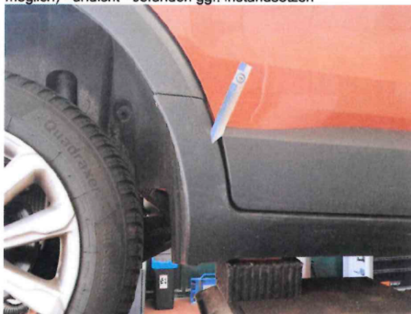
Beschädigung #13: Schweller rechts: Verkleidung - beschädigt - erneuern
