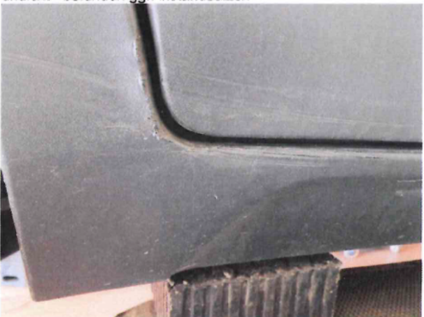
Beschädigung #13: Schweller rechts: Verkleidung - beschädigt - erneuern
