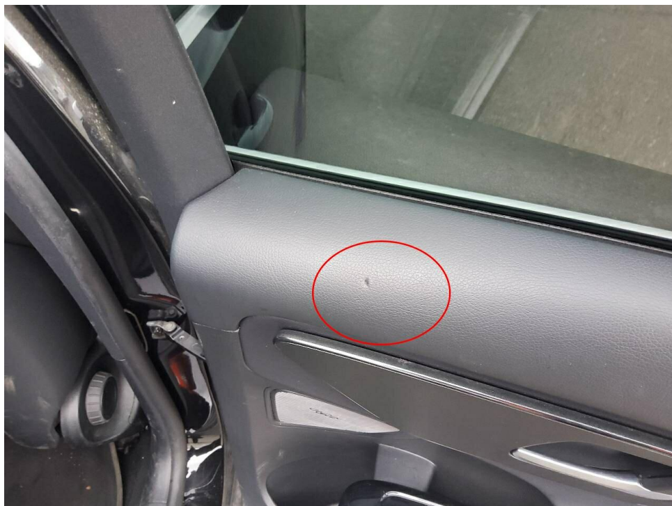
Bild 18 : Türverkleidung hinten rechts verschrammt
