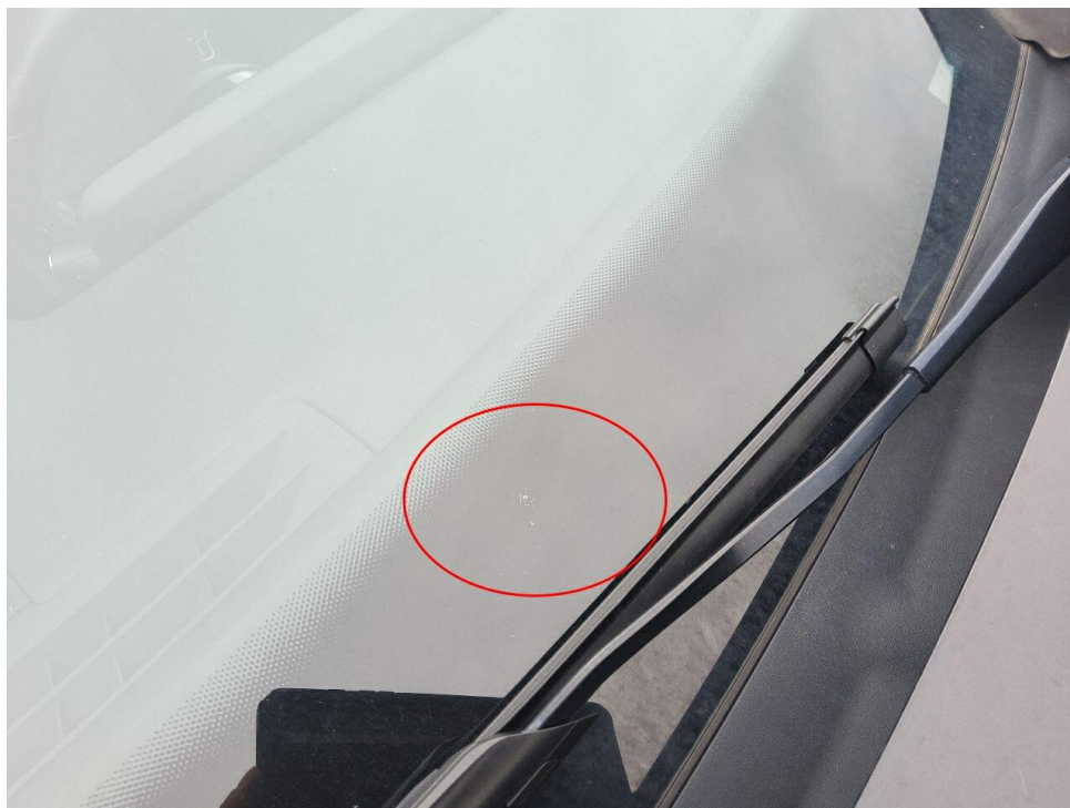
Bild 15 : Frontscheibe Steinschlag mit Riss
