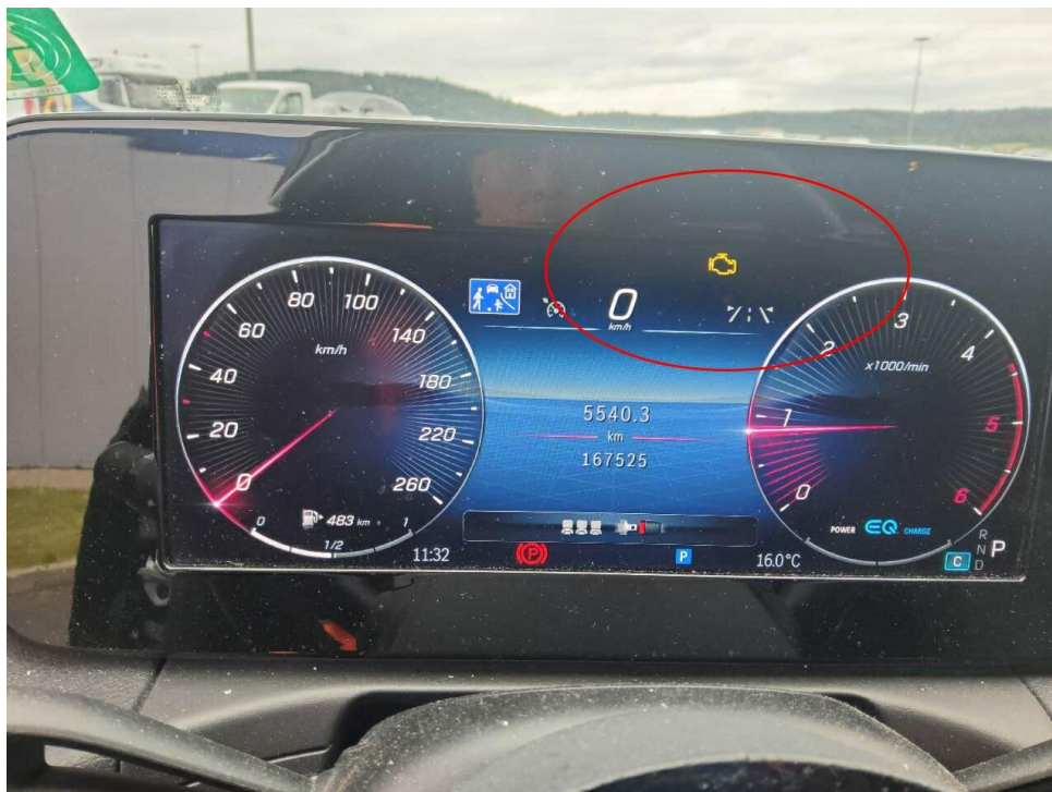
Bild 6 : Kombiinstrument (betriebsbereit) mit Km-Stand Motorlampe leuchtet auf
