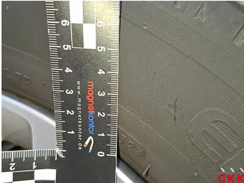
Bild 47. Reifen, vorne rechts, beschädigt, ersetzen
