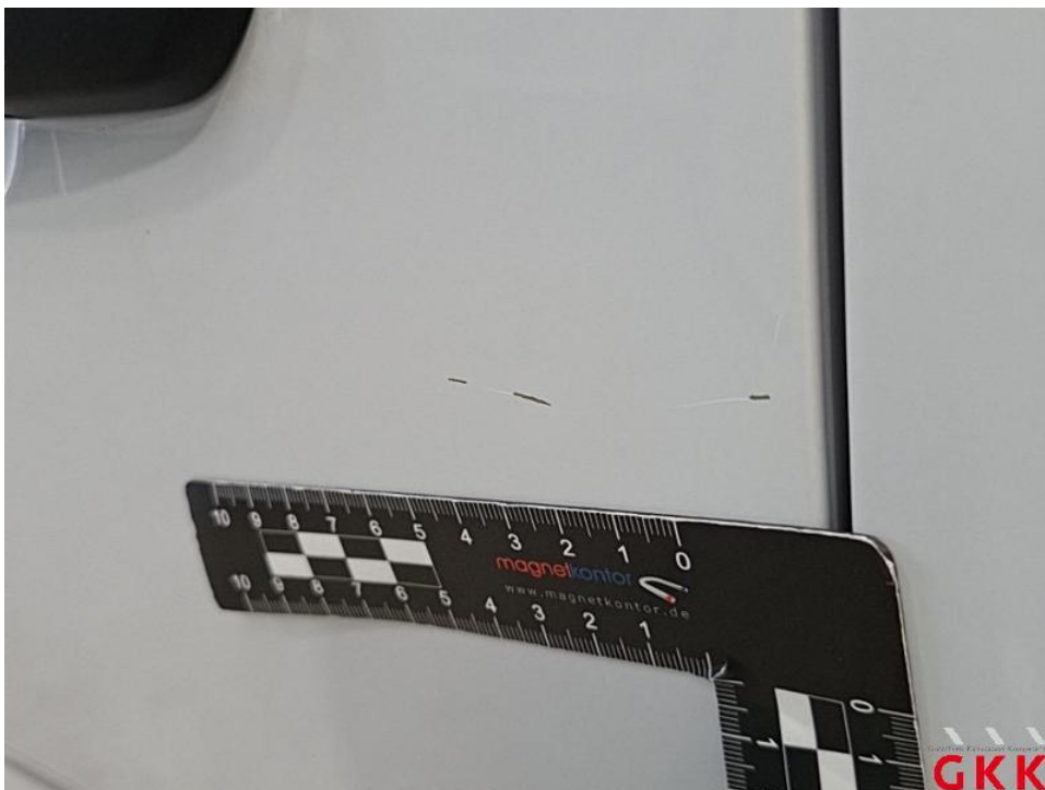
Bild 42. Schiebetür rechts, verkratzt, lackieren
