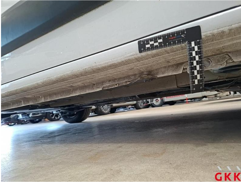
Bild 43. Schweller rechts, beschädigt, Smartrepair
