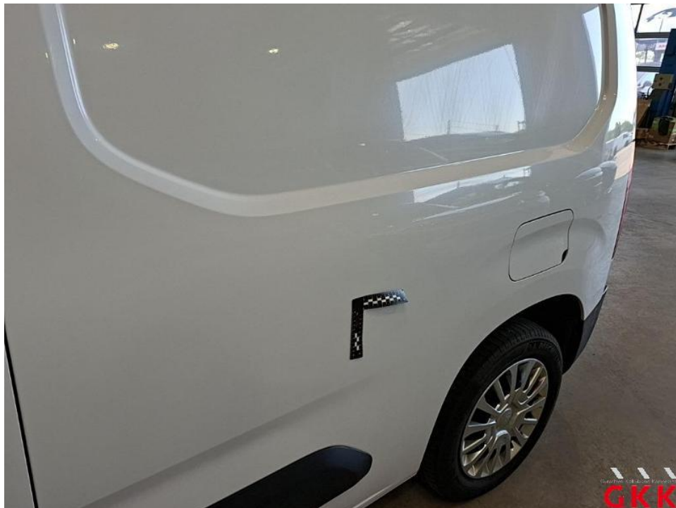
Bild 48. Seitenwand links, bis 3 Dellen / Bauteil, kalt drücken
