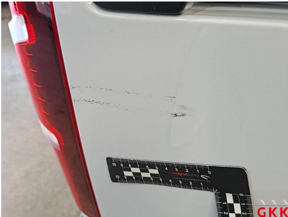
Bild 40. Seitenwand rechts, Harzanhaftungen/-rückstände, aufbereiten
