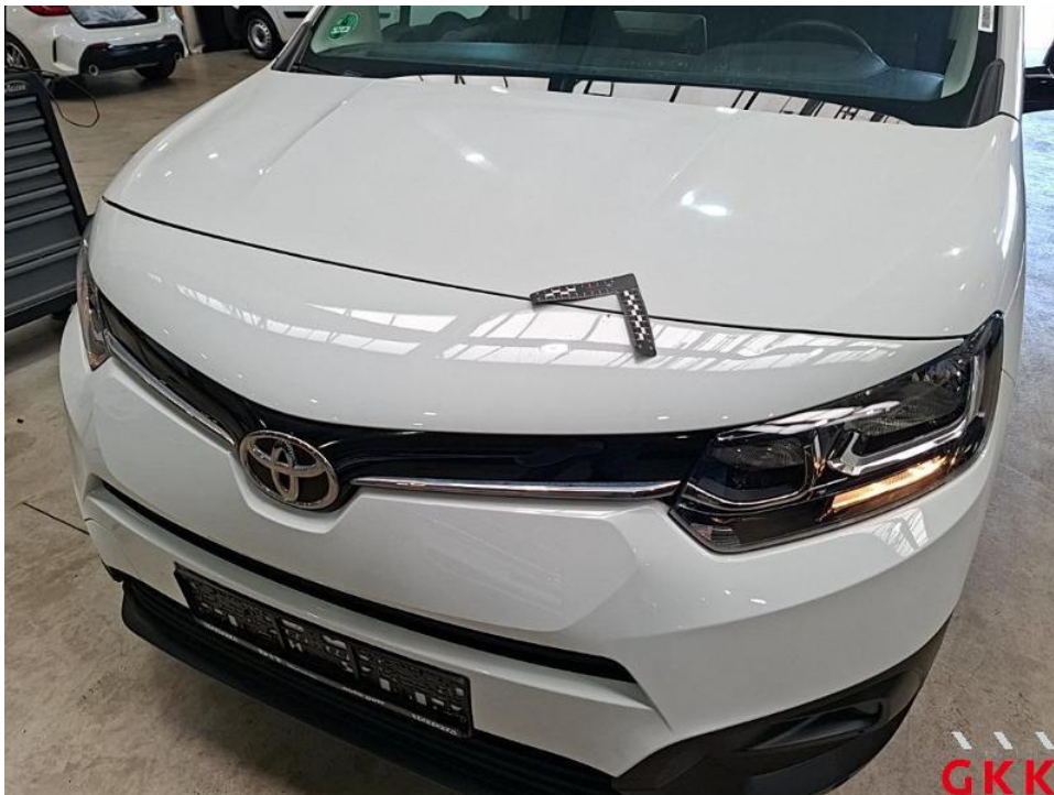
Bild 22. Stoßfänger vorne, Blende -lackiert-, verkratzt, lackieren
