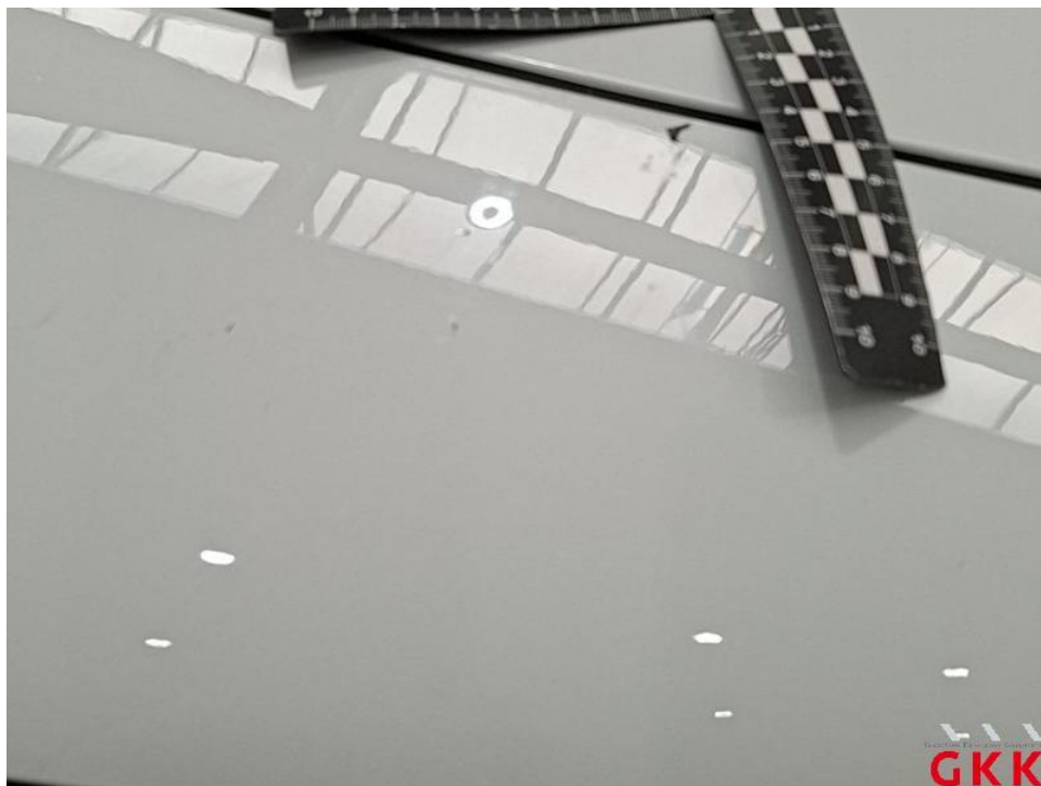
Bild 23. Stoßfänger vorne, Blende -lackiert-, verkratzt, lackieren
