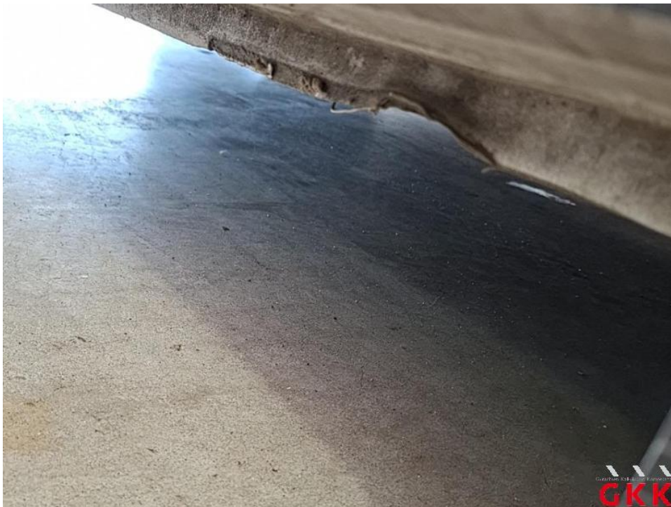
Bild 45. Schweller rechts, beschädigt, Smartrepair
