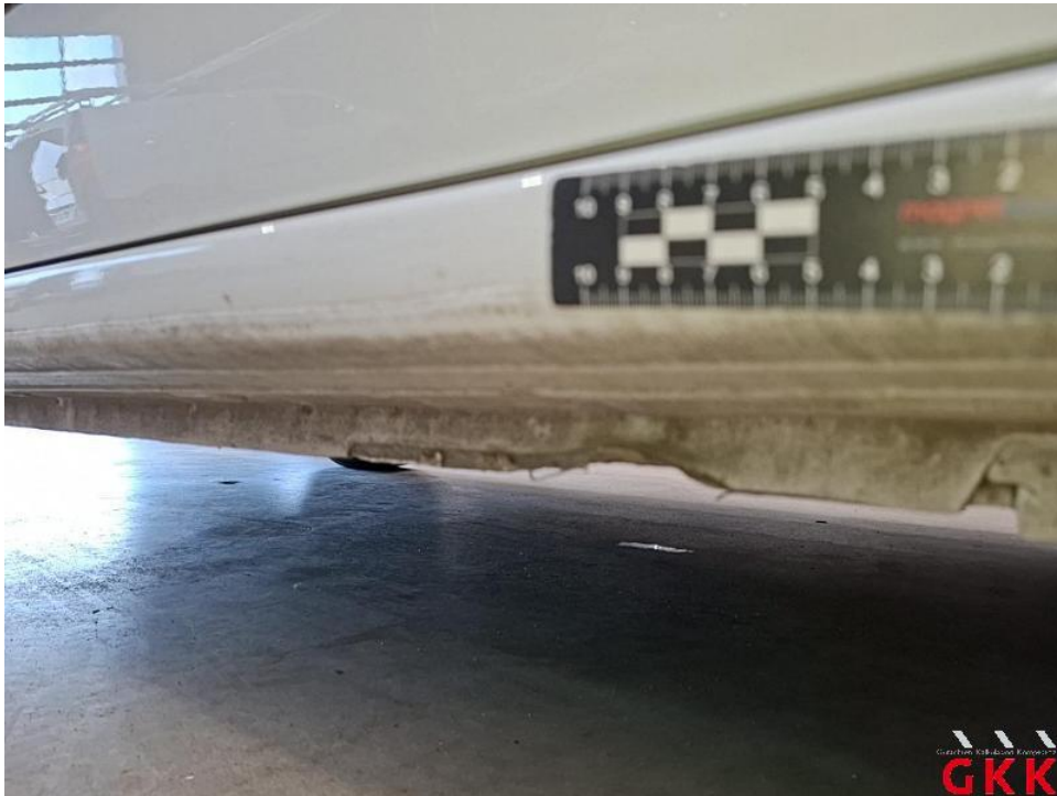
Bild 44. Schweller rechts, beschädigt, Smartrepair
