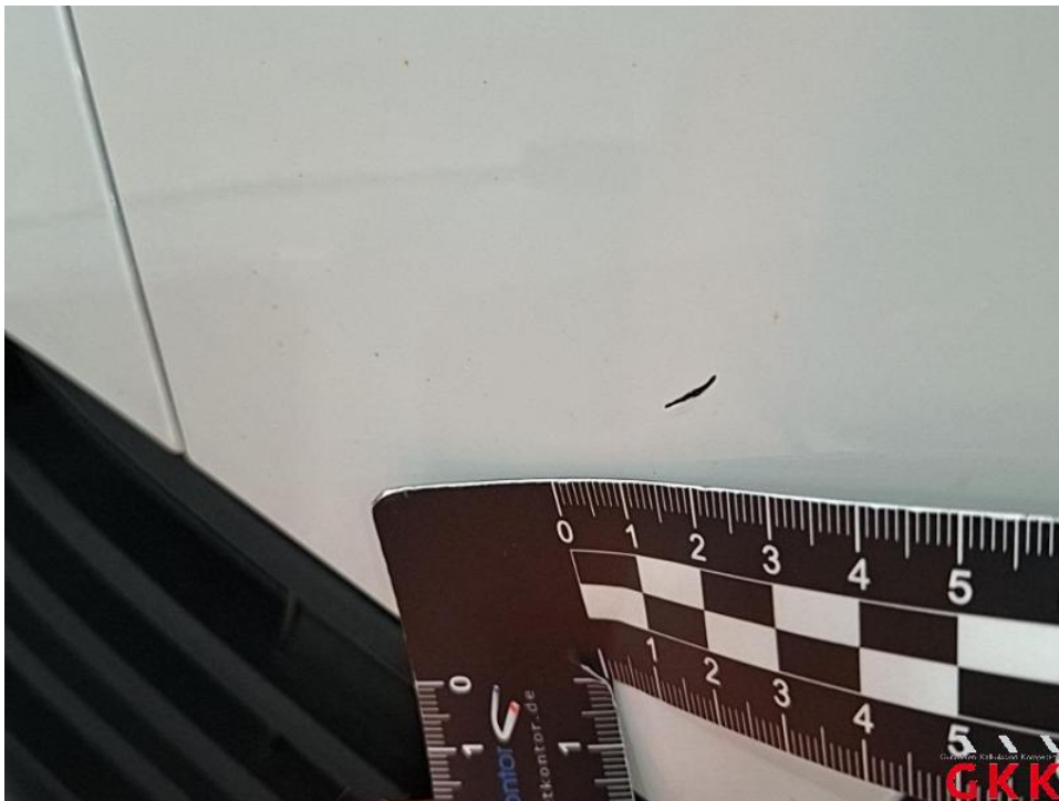
Bild 20. Stoßfänger vorne, Verkleidung oberhalb -lackiert-, verkratzt, auslegen, schleifen, polieren
