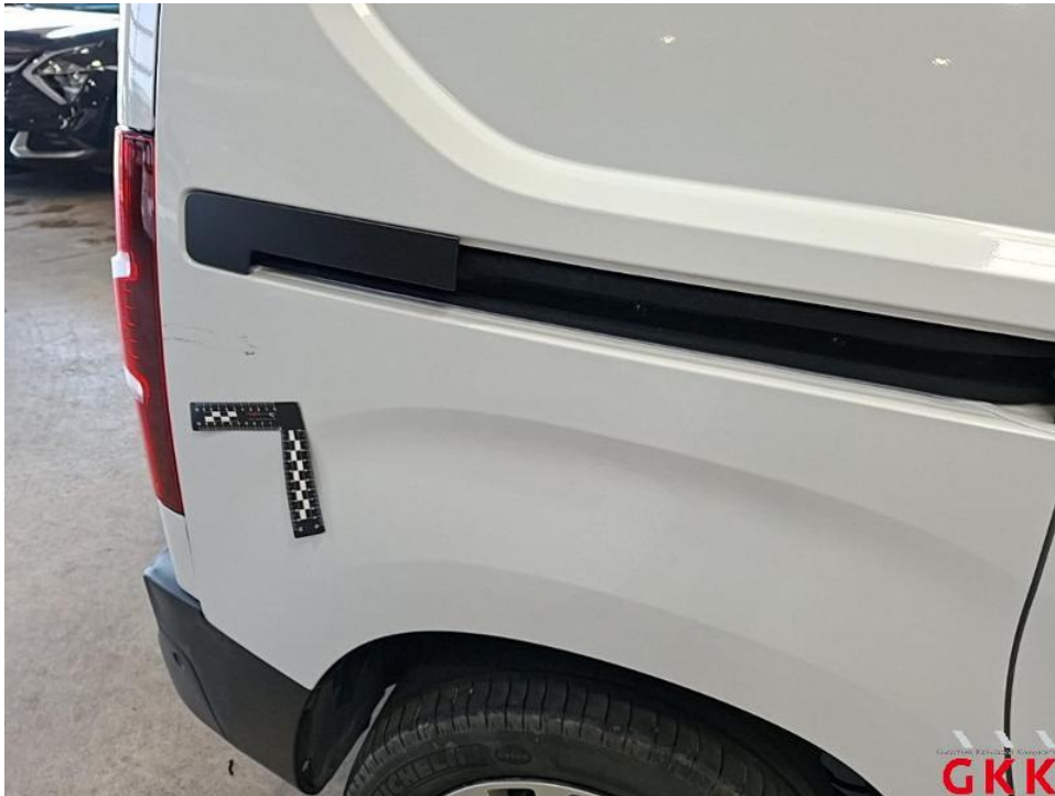
Bild 39. Seitenwand rechts, Harzanhaftungen/-rückstände, aufbereiten
