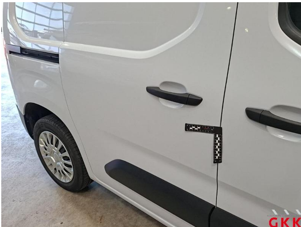
Bild 41. Schiebetür rechts, verkratzt, lackieren
