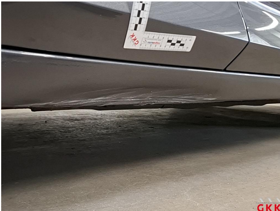
Bild 24 Schweller rechts, beschädigt, ersetzen
