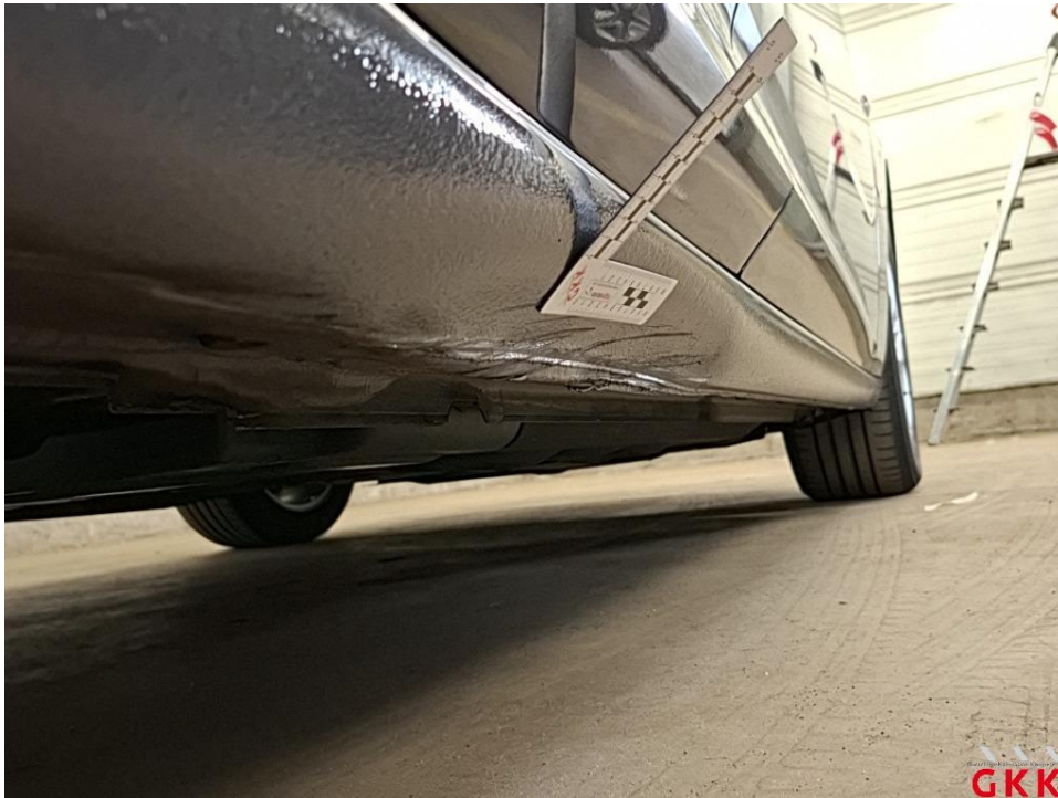
Bild 25 Schweller rechts, beschädigt, ersetzen
