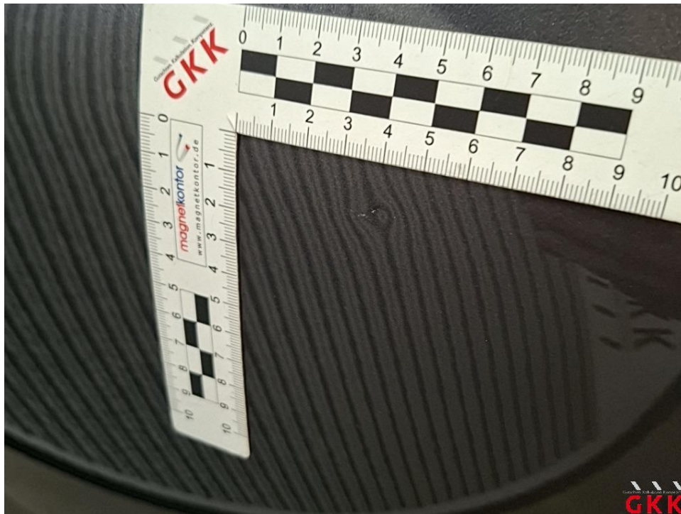
Bild 21 Tür hinten rechts, eingedellt und verkratzt (I), Smartrepair
