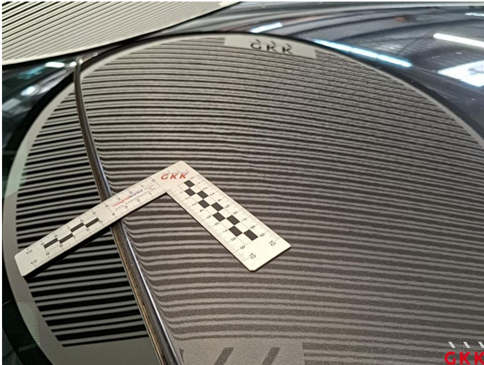
Bild 15 Dach, 4 bis 10 Dellen / Bauteil, kalt drücken
