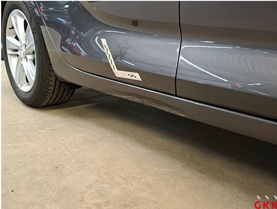
Bild 23 Schweller rechts, beschädigt, ersetzen
