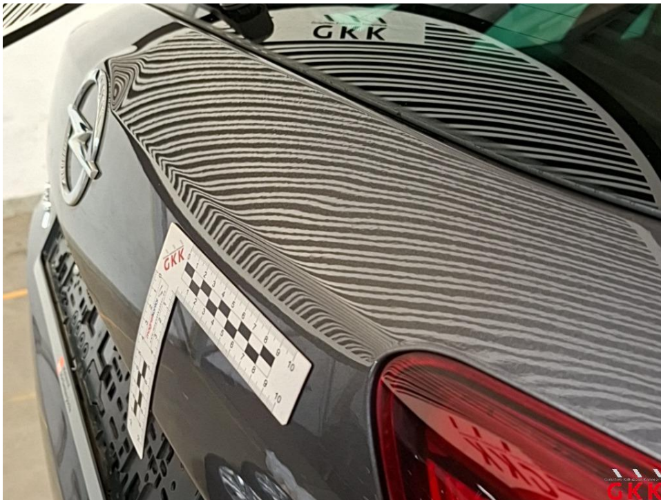
Bild 28 Heckklappe, beschädigt, kalt drücken
