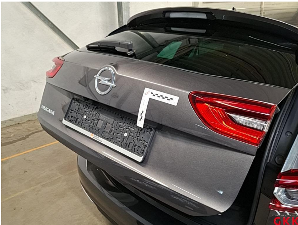
Bild 26 Heckklappe, beschädigt, kalt drücken
