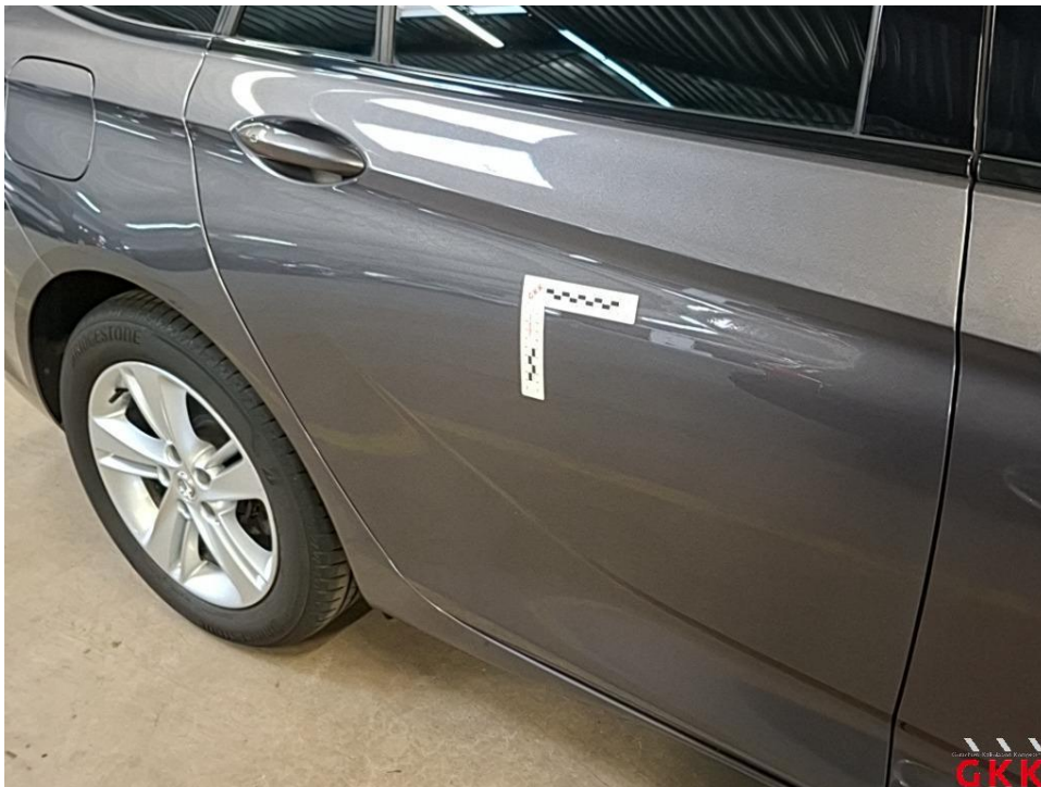
Bild 20 Tür hinten rechts, eingedellt und verkratzt (I), Smartrepair
