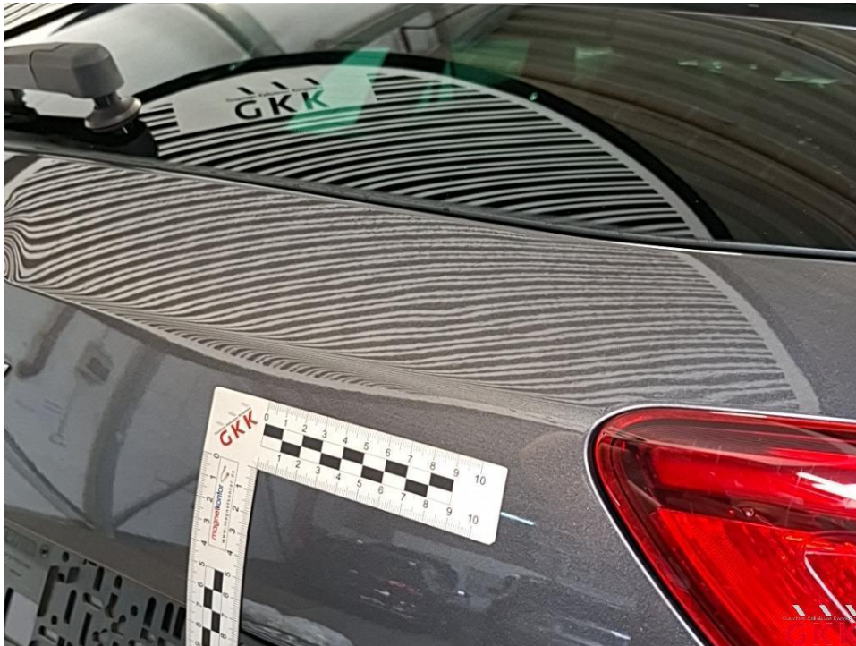
Bild 27 Heckklappe, beschädigt, kalt drücken
