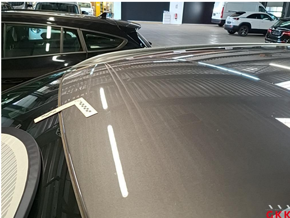
Bild 14 Dach, 4 bis 10 Dellen / Bauteil, kalt drücken
