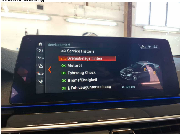
Beschädigung #3: Bremsanlage: Bremsscheiben und Beläge hinten - fällig - erneuern
