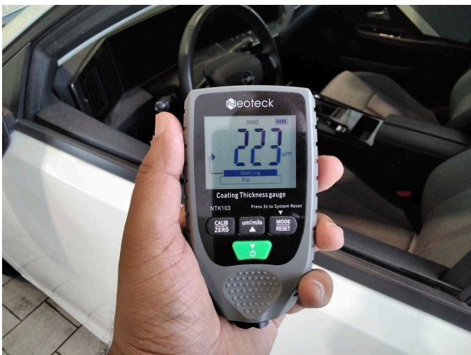
Door - front left side: 223 \mu\text{m}
