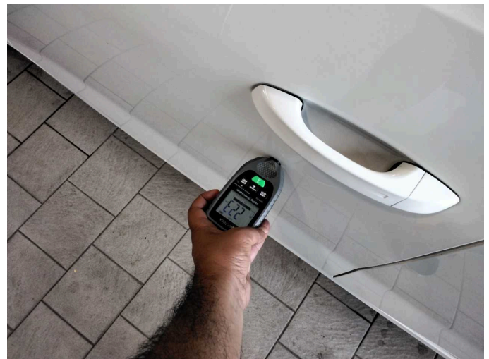
Door - front left side: 223 \mu\text{m}
