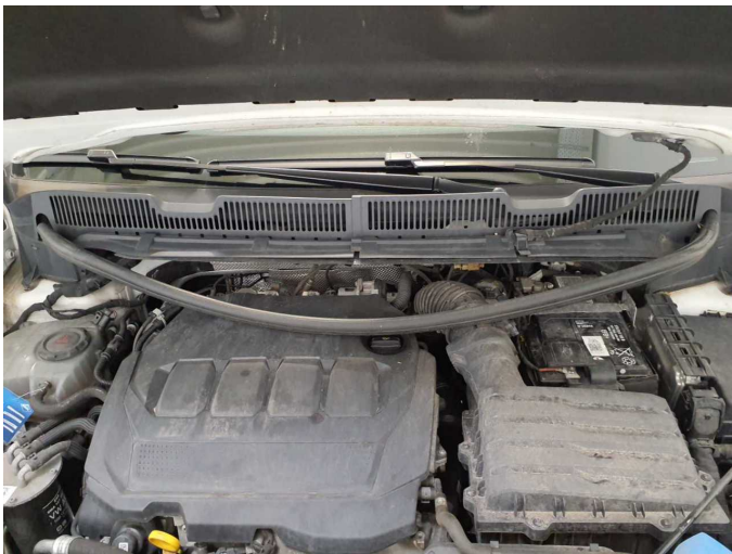
Damage 2: Bonnet: Bonnet (Dichtung) - Loose - Un- / install
