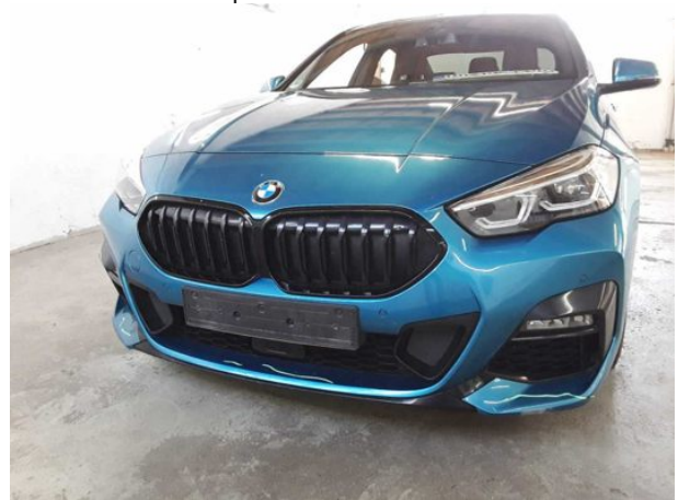
Beschädigung #8: Stossfänger vorn: Spoiler - verkratzt / verschürft - instandsetzen und lackieren
