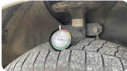
Photo de la mesure de l'usure du pneu avant droit
