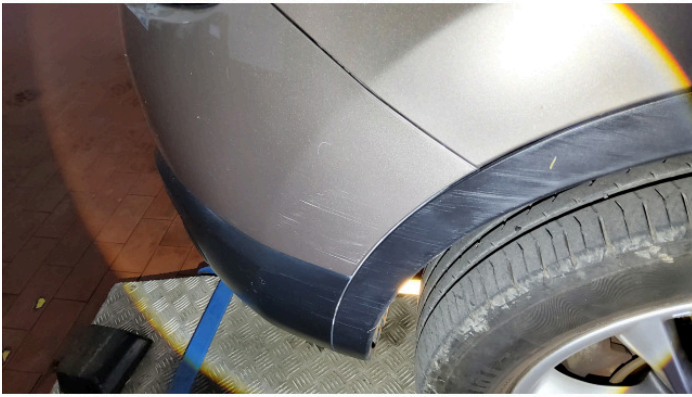
#S.01 Streifschaden links - Stoßfänger/Kotflügel/Tür v.l. (Bild 1/2)
