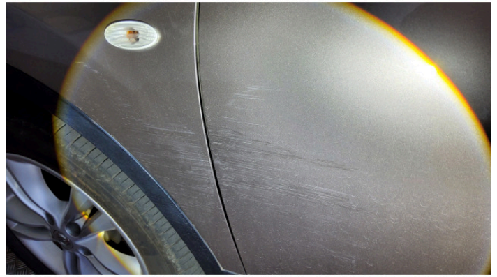
#S.01 Streifschaden links - Stoßfänger/Kotflügel/Tür v.l. (Bild 2/2)
