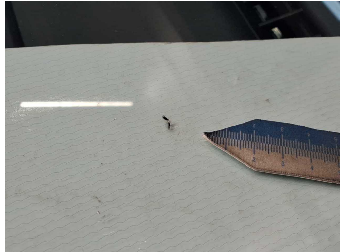
Damage 9: Vehicle glazing: Windscreen (mit Heizung) - Stone chips - Replace
