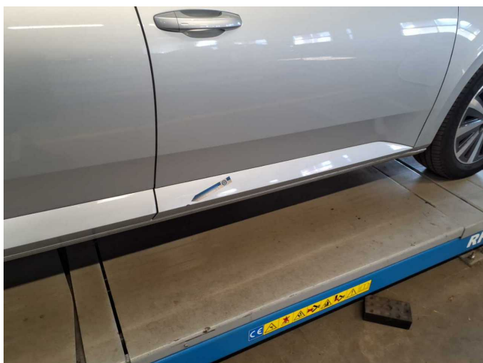
Damage 4: Door - front right side: Door (Blende unten) - Damaged - Smart repair
