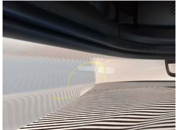
Beschädigung #2: Seitenwand rechts: Einstieg - Delle(n) - sanft instandsetzen
