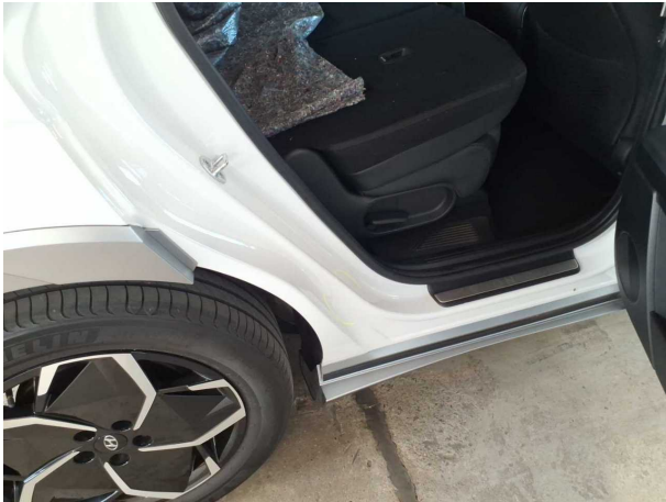
Beschädigung #2: Seitenwand rechts: Einstieg - Delle(n) - sanft instandsetzen
