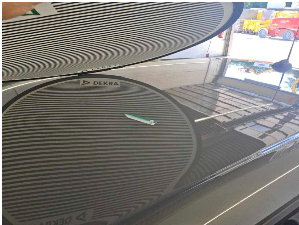
Bild 17 : Dach, eingedellt, Gebrauchsspur
