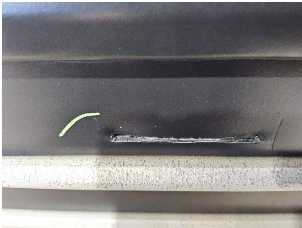
Bild 23 : Spoiler Stoßfänger hinten, gerissen und zerkratzt
