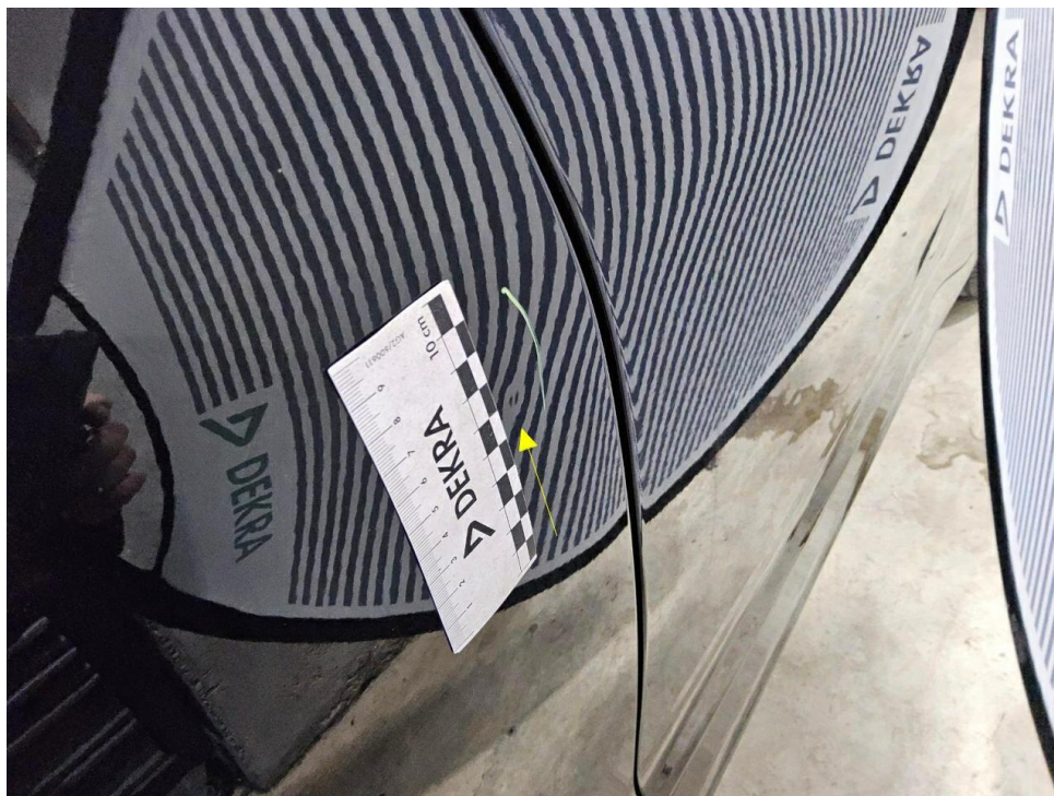
Bild 27 : Tür hinten rechts, eingedellt, drücken
