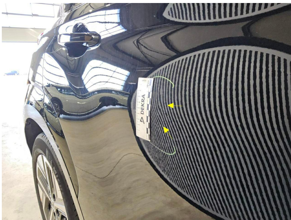
Bild 28 : Tür hinten rechts, eingedellt, drücken
