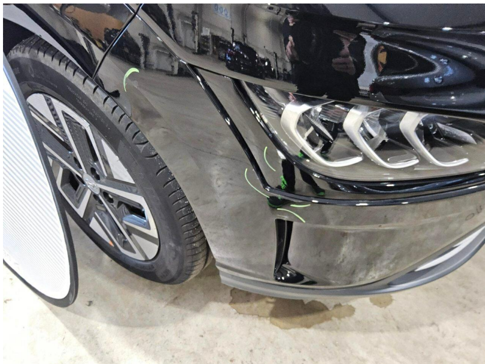
Bild 14 : Stoßfänger vorne Lackierung, zerkratzt, lackieren mit Lackaufbau
