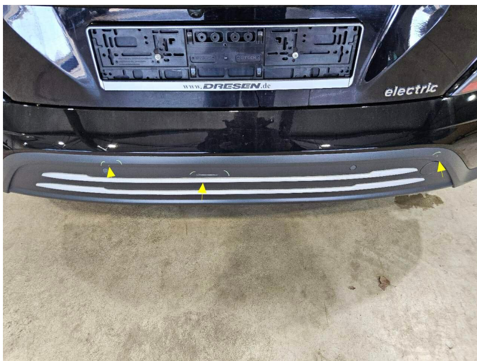
Bild 22 : Spoiler Stoßfänger hinten, gerissen und zerkratzt
