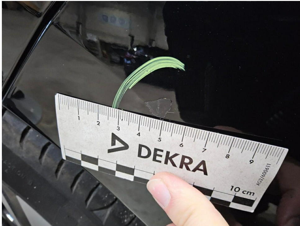
Bild 15 : Stoßfänger vorne Lackierung, zerkratzt, lackieren mit Lackaufbau
