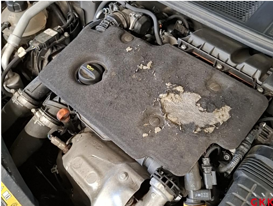
Bild 19 Motor, Abdeckung, beschädigt, ersetzen
