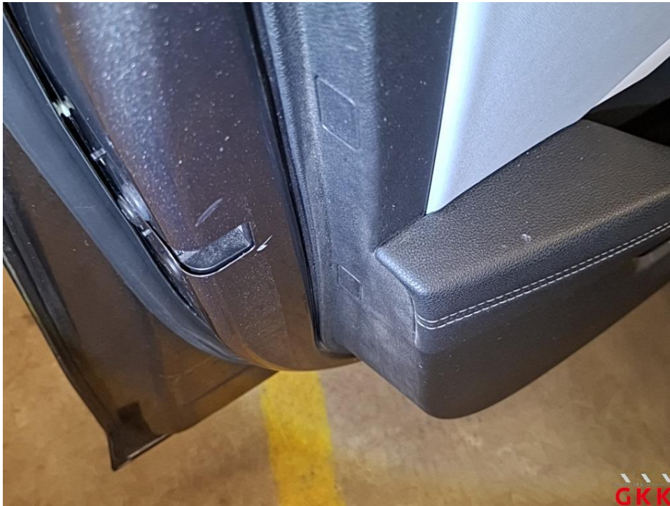
Bild 27 Tür vorne links, innen, beschädigt, Smartrepair
