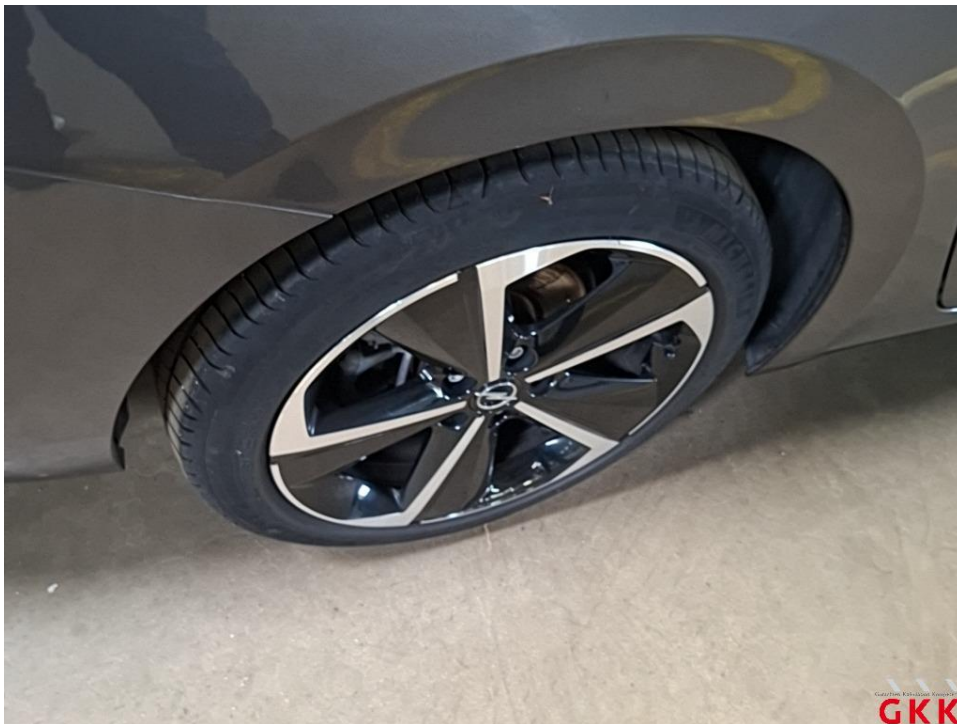
Bild 30 LM-Rad, hinten rechts, Materialabtrag, ersetzen
