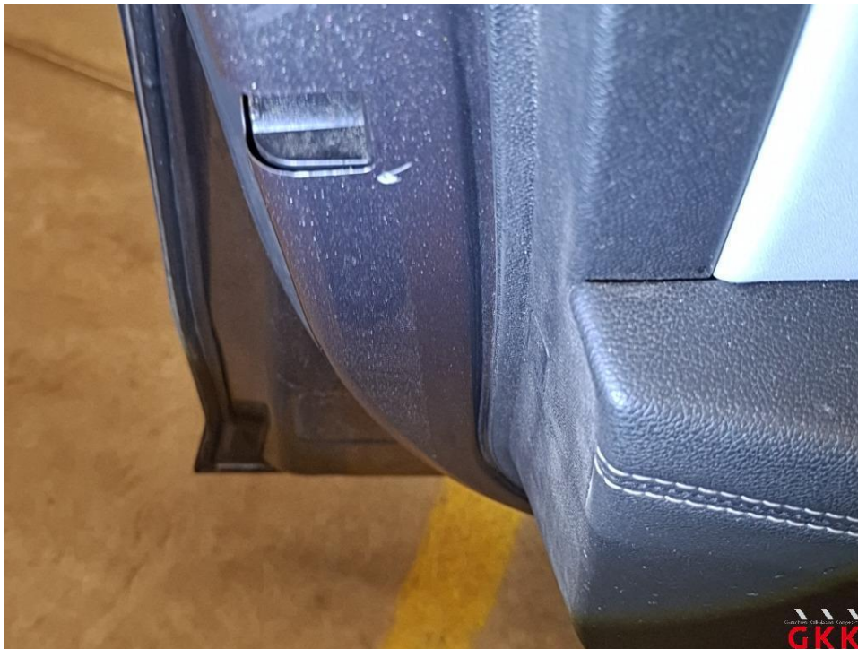
Bild 26 Tür vorne links, innen, beschädigt, Smartrepair
