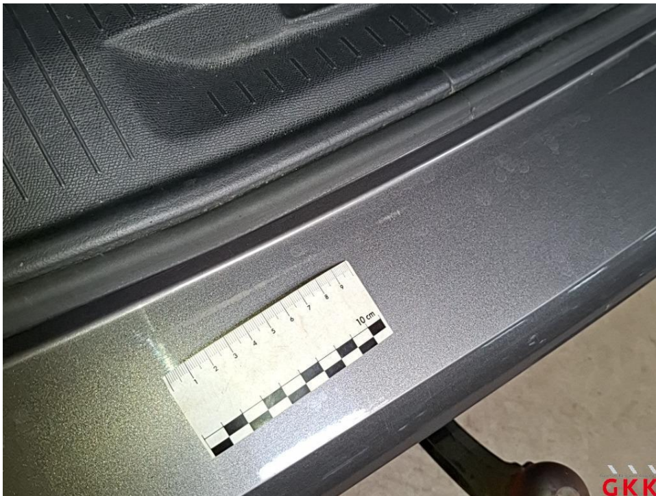
Bild 28 Stoßfänger hinten, Verkleidung -lackiert-, verkratzt, lackieren
