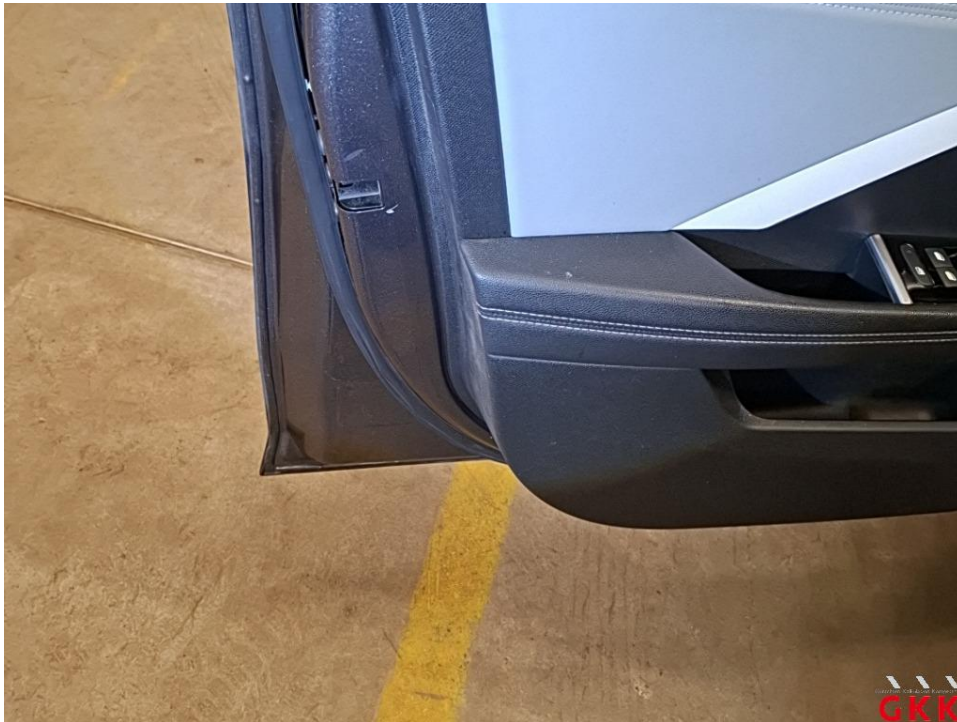
Bild 25 Tür vorne links, innen, beschädigt, Smartrepair
