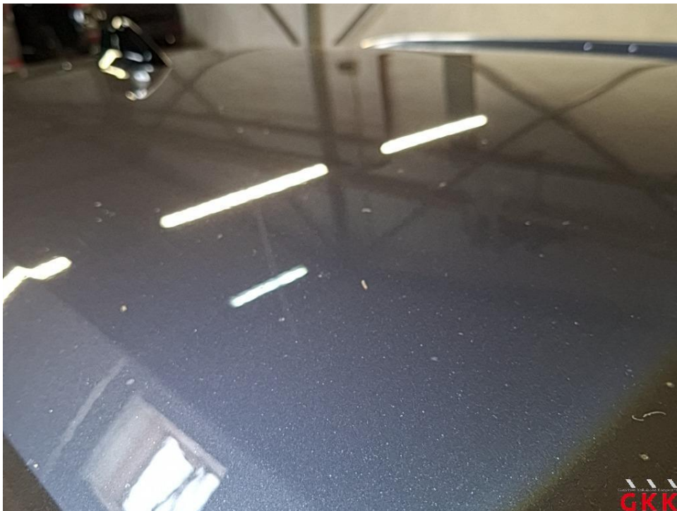
Bild 24 Fahrzeug, außen, Anhaftungsspuren, aufbereiten
