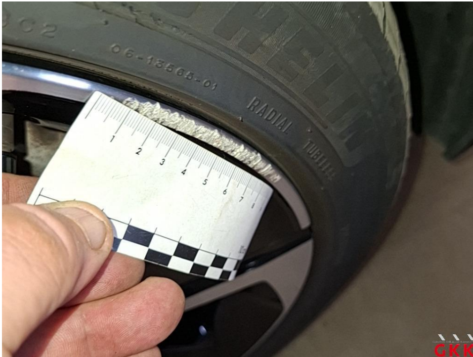
Bild 21 LM-Rad, vorne rechts, Materialabtrag, ersetzen
