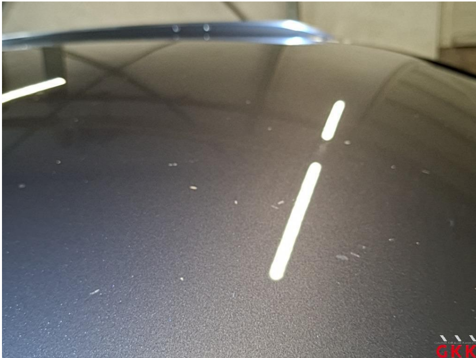
Bild 23 Fahrzeug, außen, Anhaftungsspuren, aufbereiten
