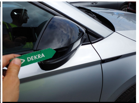
Carcasa del espejo de la puerta exterior / Derecha / Rayado
