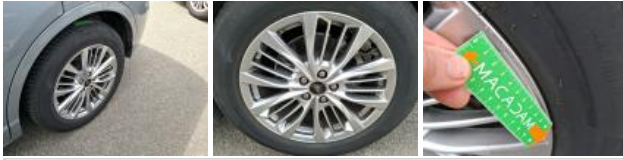
Alloy rim FR, Scratch(es), Repair/replace (lump sum)
