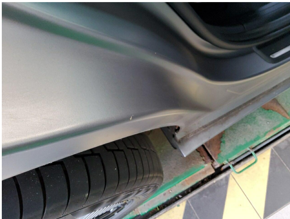
Bild 7 : Türeinstieg hinten rechts Kratzer
