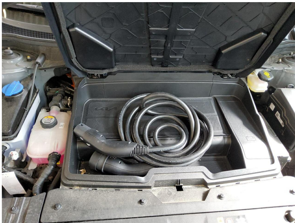
Bild 6 : Ladekabel beim E-Fahrzeug
