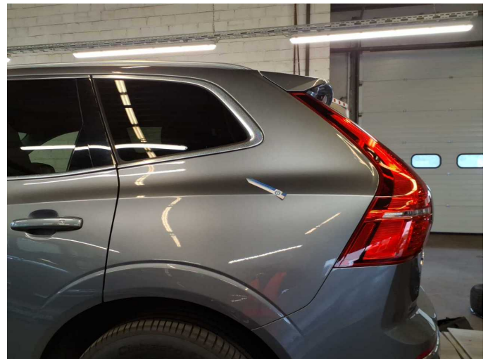
Damage 6: Side panel - rear left side: Side panel (Vogelkotverätzung-Mehrkosten möglich) - Paint defect - Conditioning
